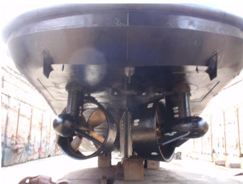
Kuva 22. Aluksen pohja ja potkurilaitteet maalattuina.
