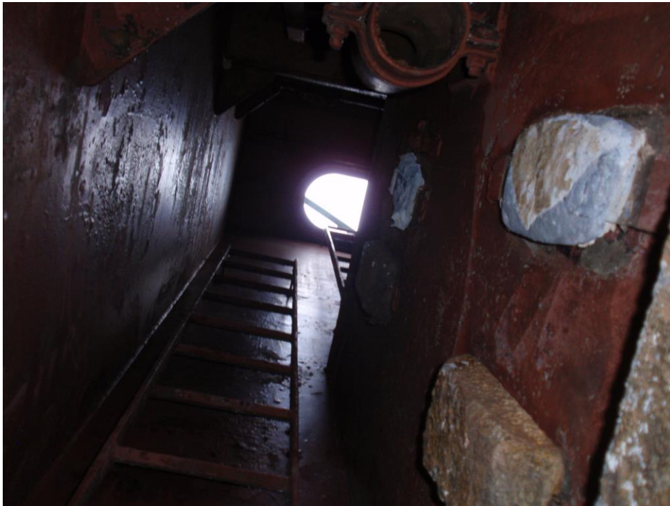
Kuva 23. Apollonin keulimmainen merivesikaivo ennen huoltoa alhaalta kuvattuna. (Jan-Kristian Lindroos 2015)
