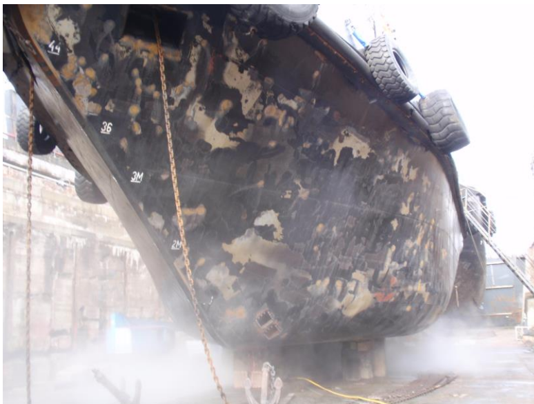
Kuva 21. Pohjan korkeapainepesu käynnissä.
