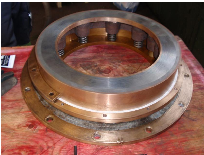
Kuva 16. Uusien osien asennus puhdistettuun runkoon. (Jan-Kristian Lindroos 2015)
