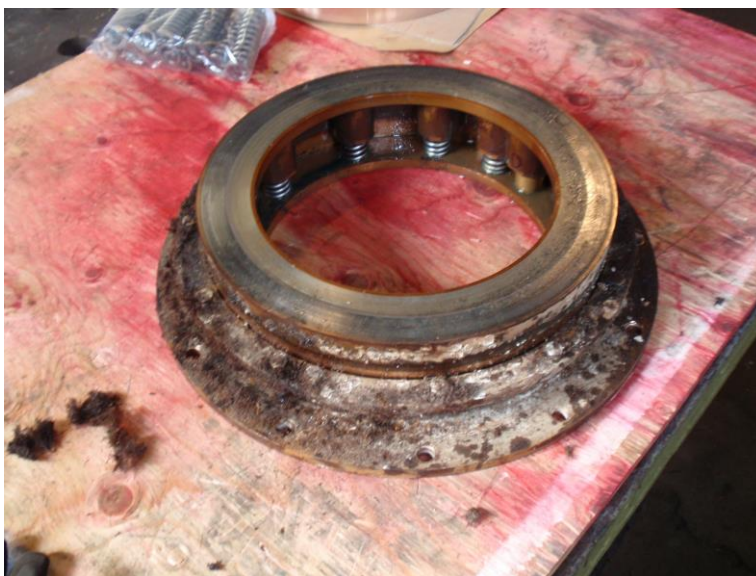
Kuva 14. BB-puolen potkurilaitteen vanha Cedervall-tiiviste irrotettuna verstaalla. (Jan-Kristian Lindroos 2015)
