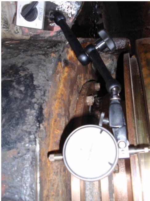
Kuva 19. Mittakello indikoimassa potkurin siirtymää suhteessa potkuriakseliin. (Jan-Kristian Lindroos 2015)
