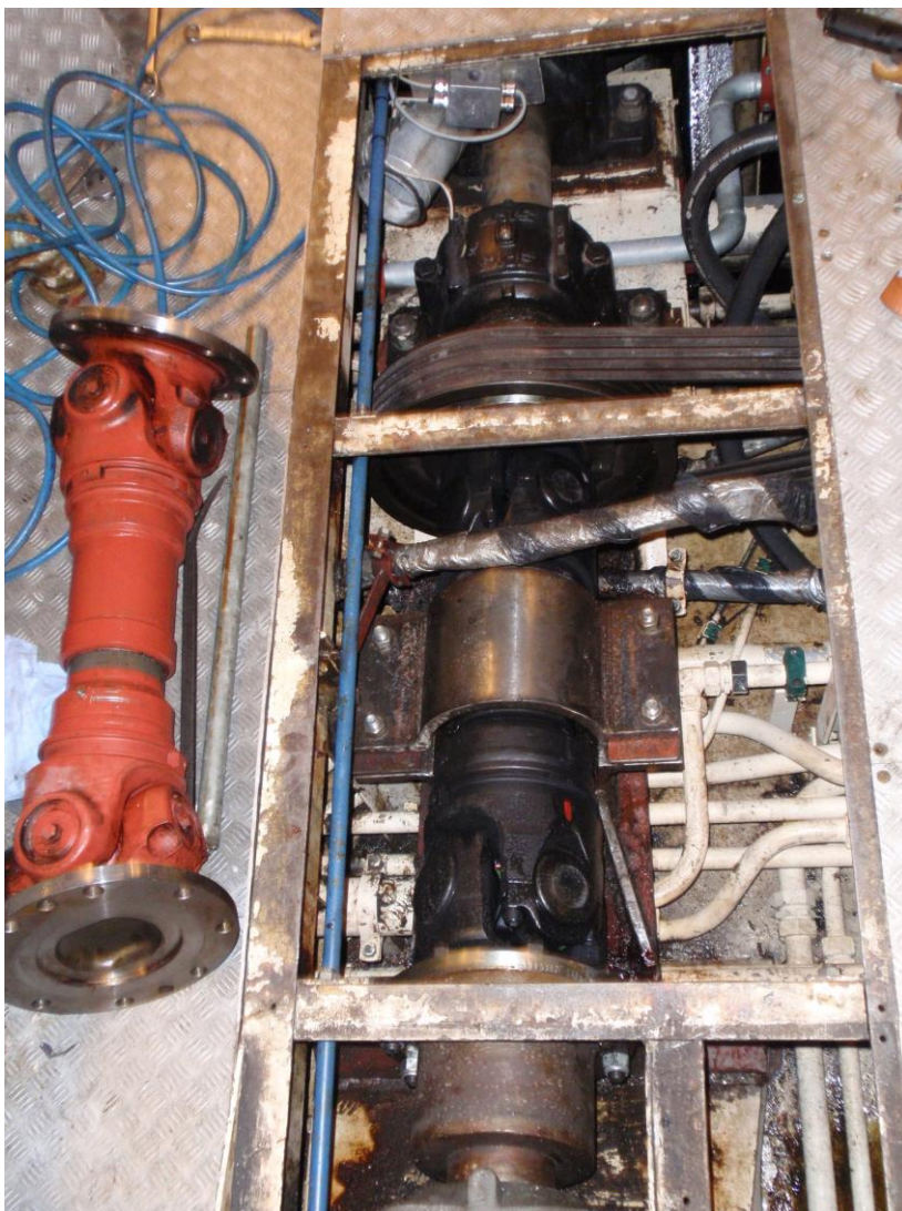
Kuva 28. Uusi nivelakseli asennettuna. (Jan-Kristian Lindroos 2015)
