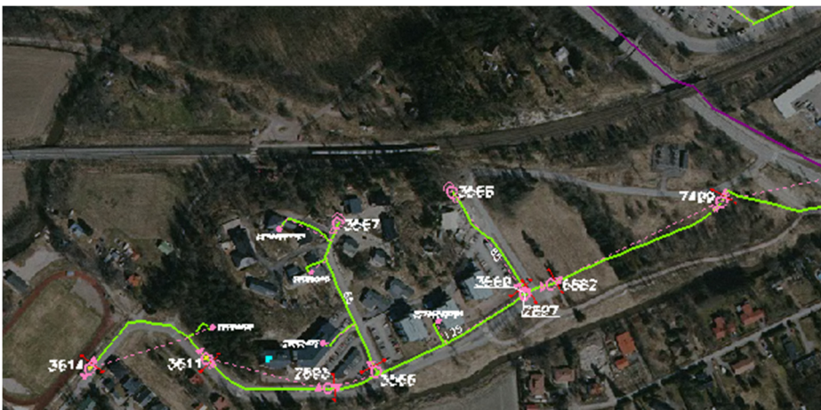
Figur 27: Från brunnen 6882 (andra från höger) stängdes nätet för läckagereparering och området till vänster om brunnen blev ett eget värmeområde.
