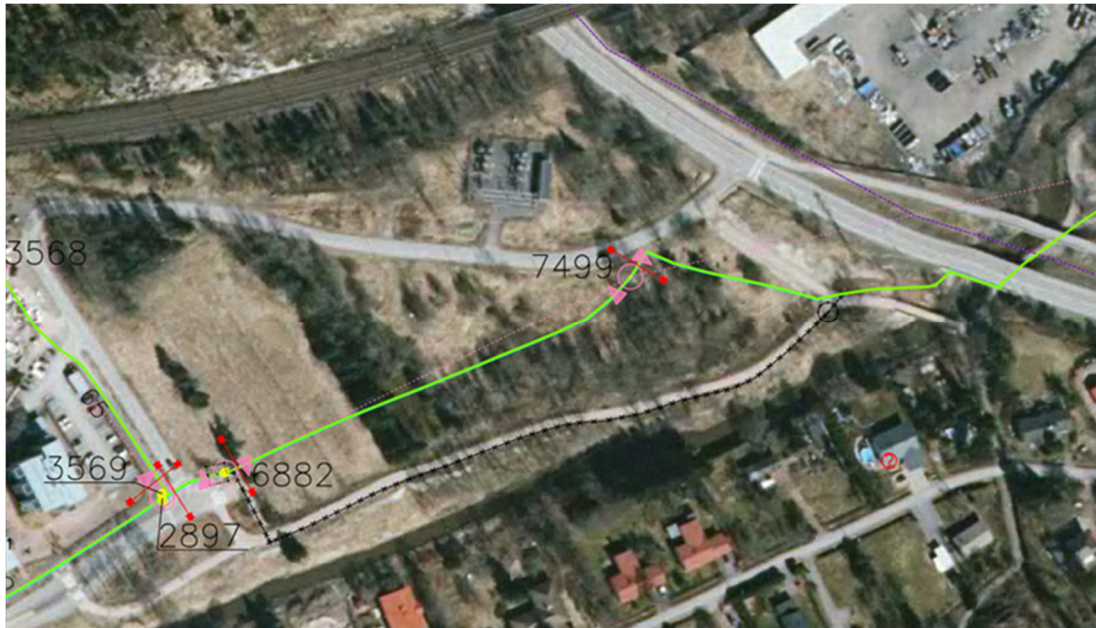
Figur 25: Kartan över rasområdet i Lasimäki. Den ursprungliga linjen sträckad och nya linjen med grön färg.
