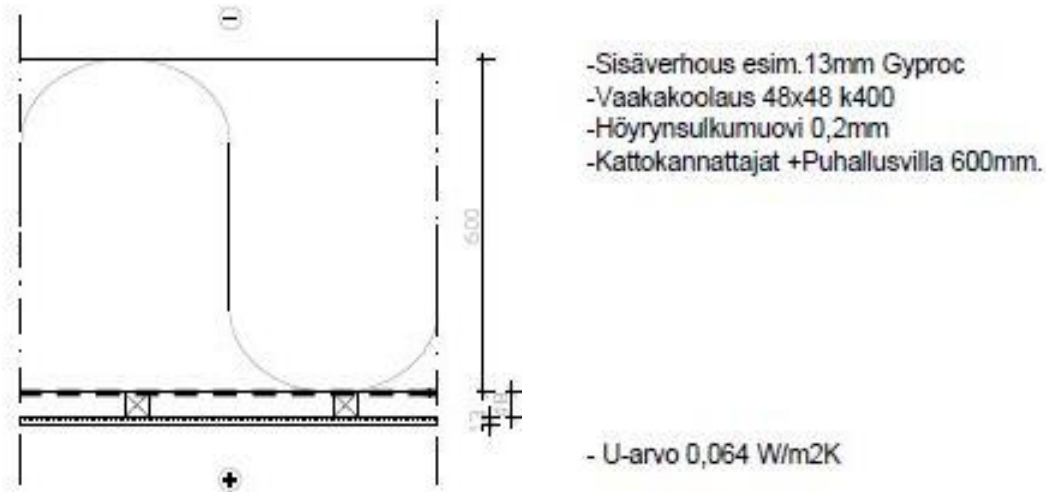
KUVA 11. Vanhan puolen uusi yläpohjarakenne katon suoralla osuudella
