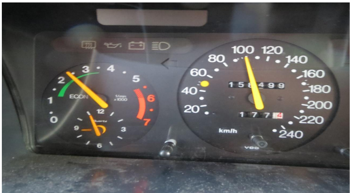
Kuva 9. Ensiövälityksen muutoksen vaikutus (GM45712) 5-vaihteella testiajossa
