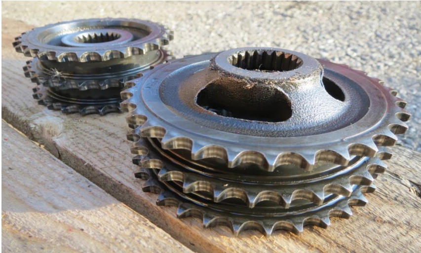
Kuva 6. Ensiövälityksen rattaat, 31 ja 26 hammasta
