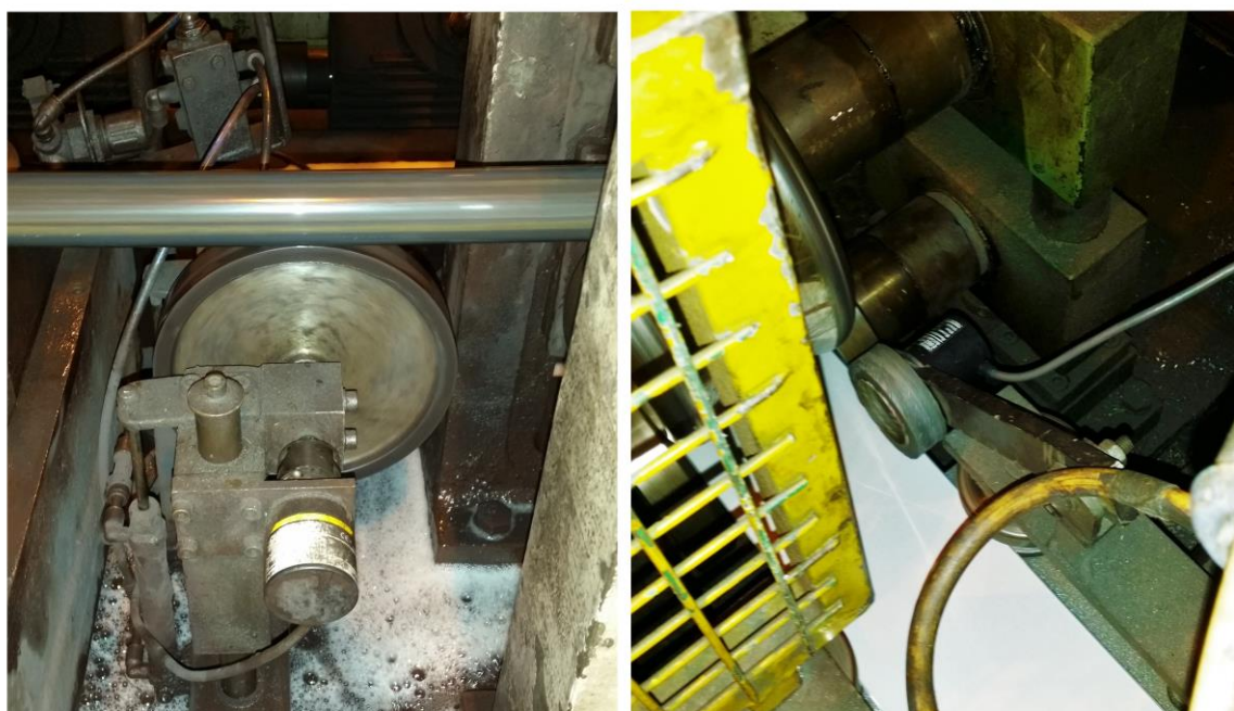
Figur 20. Mätjulet till vänster hör till kalibrerdelen och det högra till formdelen.
