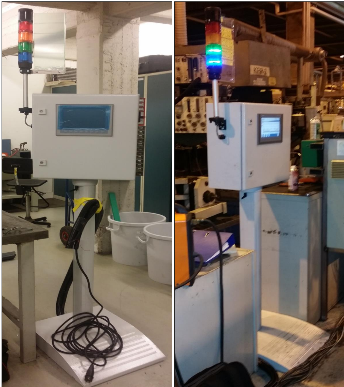
Driftövervakningssystemet hopmonterat till vänster och driftsatt till höger.
