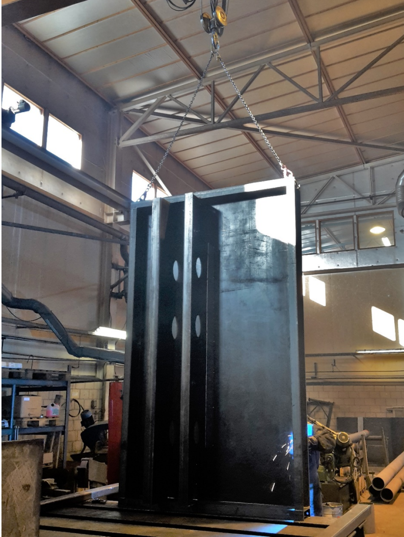
Kuva 13. Koneikon runko käsinhitsattavana.
