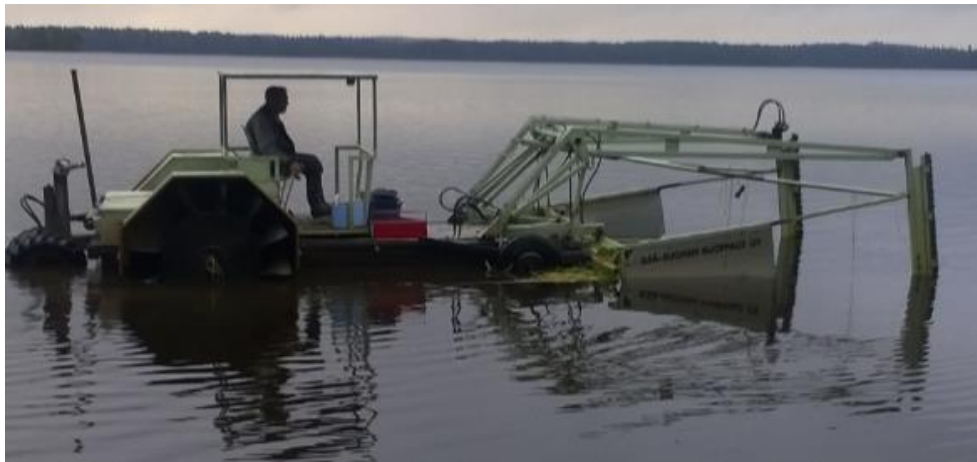
Kuva 13. Vesikasvillisuuden poistoon tarkoitettu niitto- ja jyrsinkone työssä (kuva Tuomo Mäkelä)
