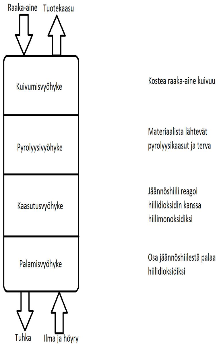
Kuvio 2. Vastavirtakaasuttimen toimintaperiaate.
