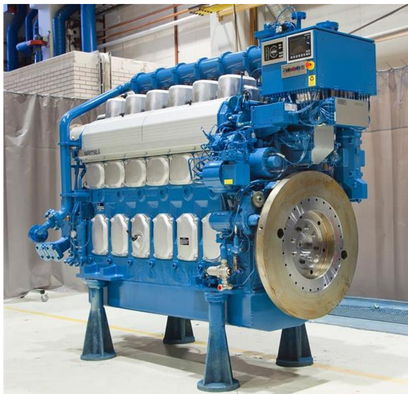
Kuva 2. Wärtsilä 20DF kuusisylinterinen rivimoottori
