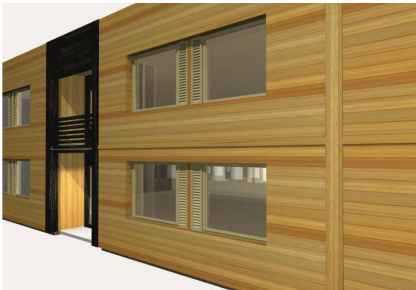
Figur 29. Alternativ ny framsida, vertikala träelementskarv synliga.
