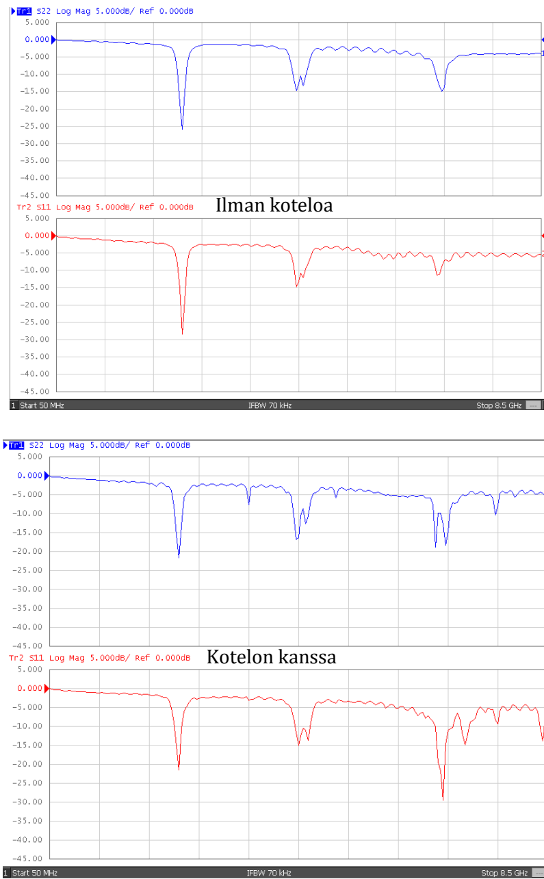
Kuva 21. Suodattimen paluuhäviöt S_{22} ja S_{11} . 50 MHz — 8,5 GHz.
