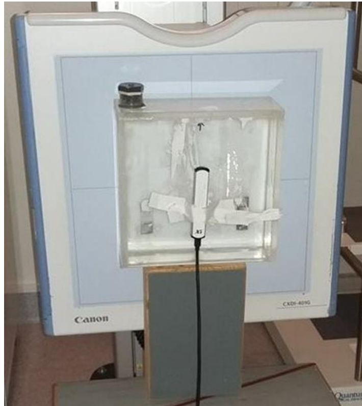
Kuva 1. Thorax-fantom ja ESD-mittari pystytelineellä. (Kuva: Jessi Grönberg, 2015)
