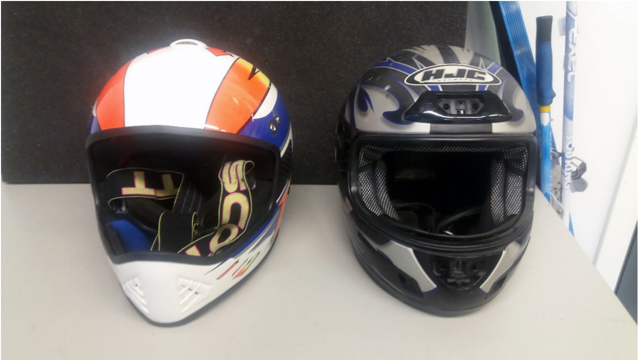
Kuva 26. Tutkimuksessa selvitettiin kahden moottoripyöräilijän kypärän rakenne ja lujitemuovipitoisuus (Kuva Dick Blom)
