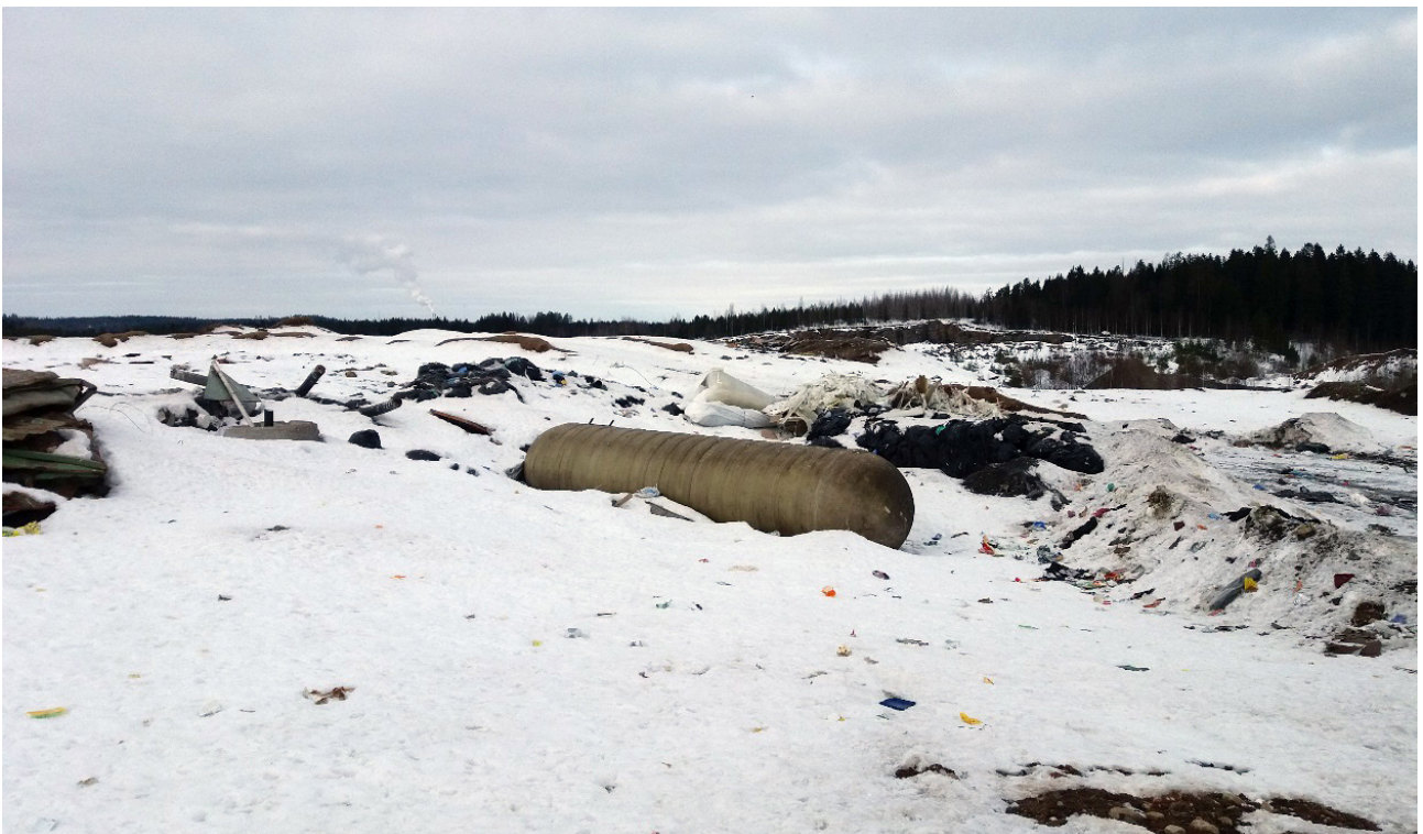
Kuva 19. Käytöstä poistettu lujitemuovinen lokasäiliö loppusijoitettavana kaatopaikan penkkaan (Kuva Dick Blom)
