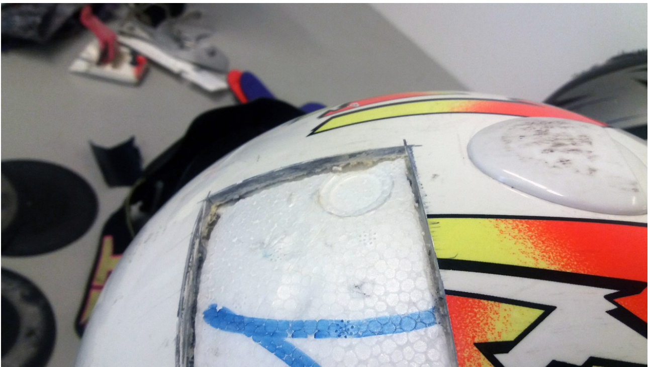
Kuva 27. Kypärän ulkokuori on paksuudeltaan noin 4 mm. Tässä kypärässä merkintä "Carbon/Aramid Composite". Sisäkuori polystyreeniä (Kuva Dick Blom)
