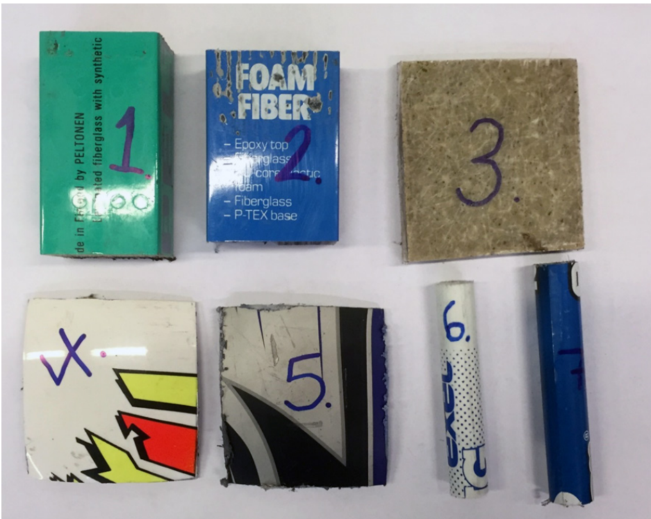
Kuva 30. Analysoiduista lujitemuovituotteista otetut näytteet ennen polttokoetta
