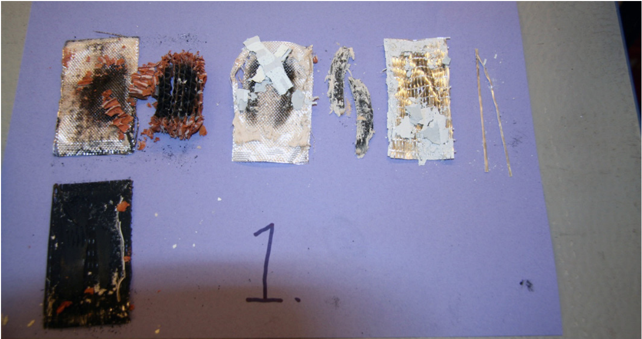
Kuva 31. Suksinäyte no 1 polttokokeen jälkeen. Jäljellä lujitteita, aramidikennoa ja suksen pohjan muovikerrosta.
