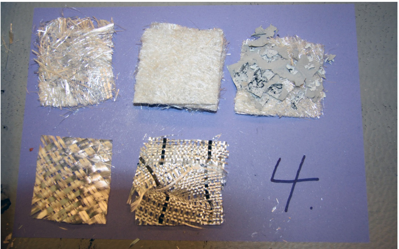
Kuva 34. Moottoripyöräilijän kypärästä otettu näyte no 4. Polttokokeen jälkeen jäljellä oli lasilujitteita sekä hyvin pienimäärä hiilikuitulujitetta. Kypärässä valmistajan merkinnän mukaan pitäisi aramidi -hiilikuitulujitteita. Toisen kypärän kuori, näyte no 5, oli lujittamatonta kestumuovia.
