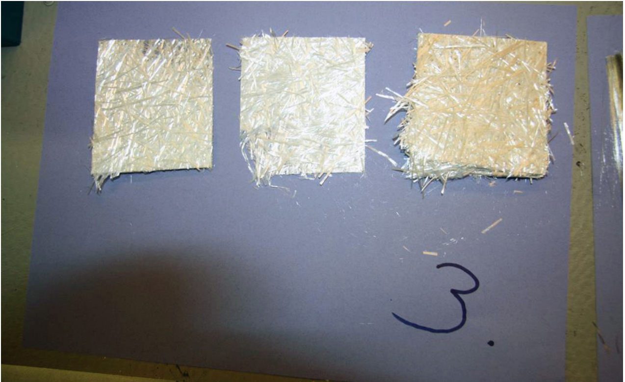
Kuva 33. Murskatusta veneestä otettu näyte polton jälkeen. Lasilujitteita.
