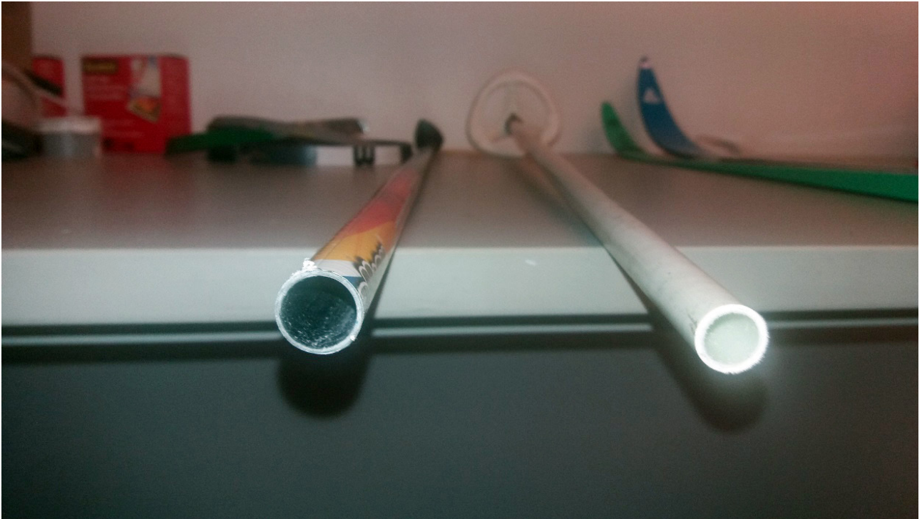
Kuva 25. Kävelysauvan ja suksisauvan poikkileikkaukset (Kuva Dick Blom)
