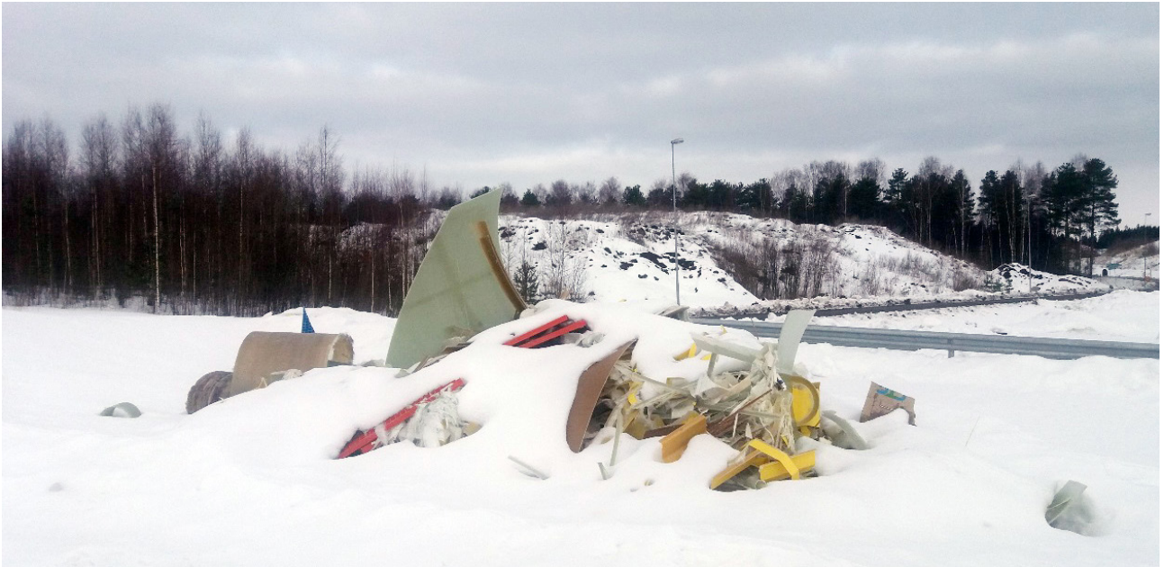
Kuva 10. Puhdasta lujitemuoviteollisuuden leikejätettä kaatopaikalle sijoitettuna. Tämä materiaali soveltuisi hyvin sementti-uunin kierrätyspolttoaineen valmistukseen (Kuva Dick Blom)
