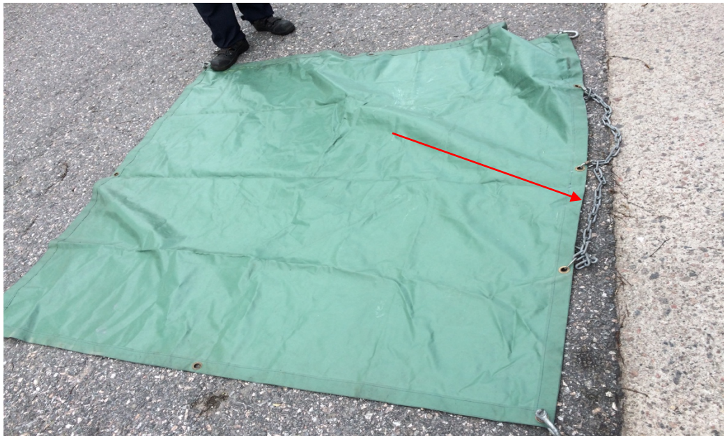
Kuva 11. Puolustusvoimien käyttämä vuotomatto pressukankaasta, nuoli näyttää ketjun joka pitää maton irti aluksen kyljestä sekä vetää veden alle.
