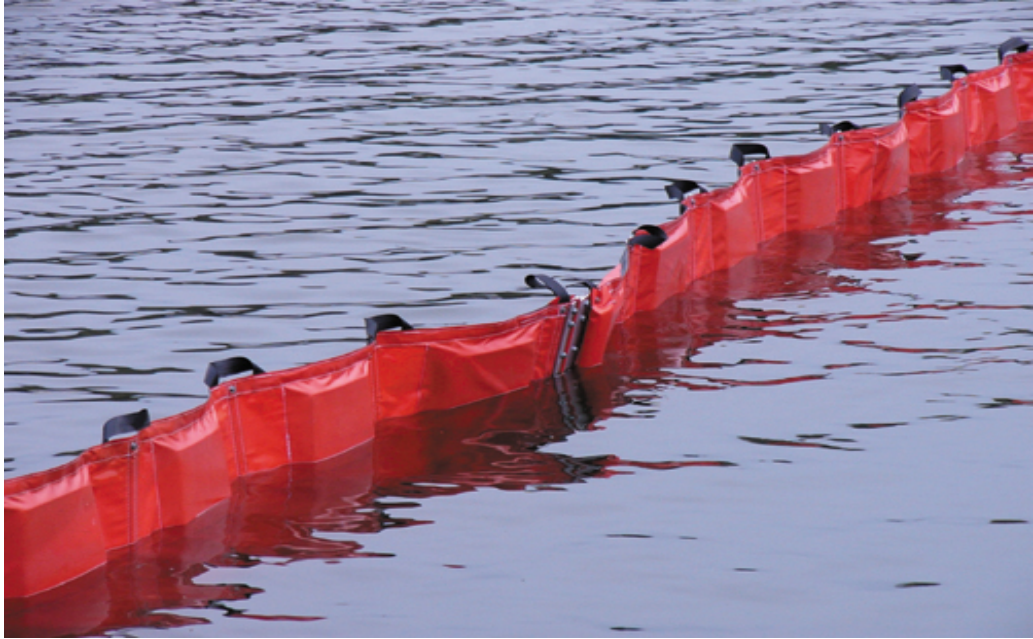
Kuva 9. Troilboom öljynhallintapuomi, tarkoitettu sisävesille ja kevyeen käyttöön.
