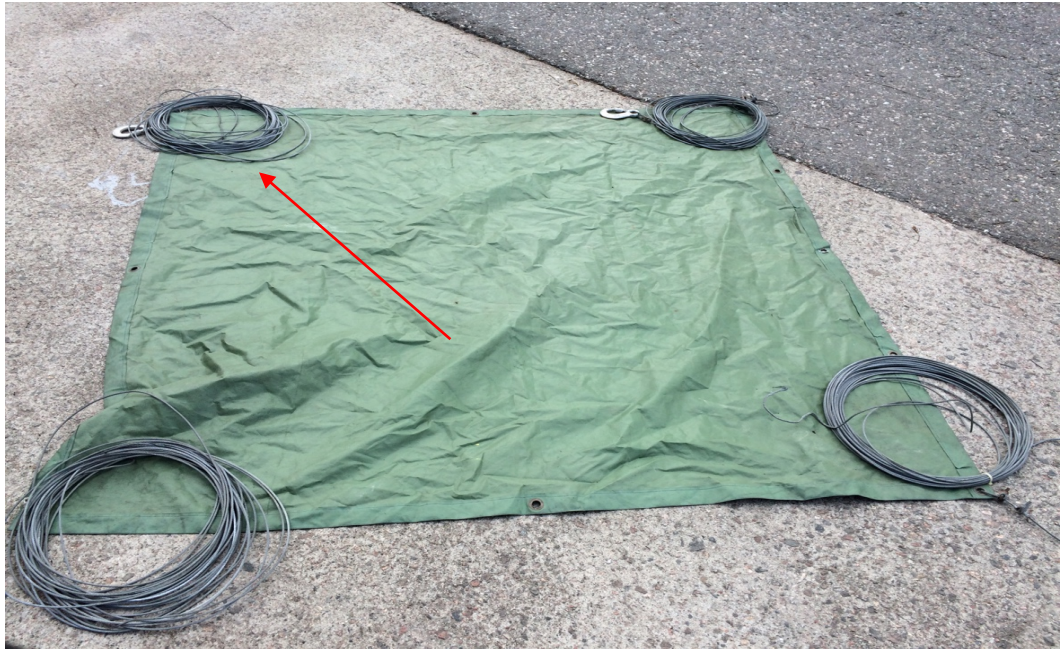
Kuva 12. Puolustusvoimien käyttämä vuotomatto, jossa vaijerit reunoissa maton paikalleen asettamisen auttamiseksi.
