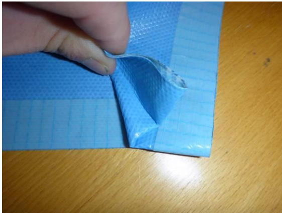
Kuva 21. Liitosnauhaa taitettaessa jää ilmayhteyksiä liitoksen läpi niille alueille, joissa nauha ei liimaudu liitospinnoille.
