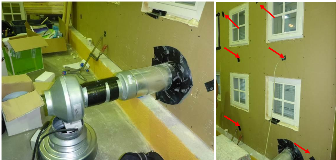
Kuvat 4 ja 5. Testijärjestely vasemmalla alipaineistukseen käytetty kanavapuhallin, oikealla merkkikaasun syöttöpisteitä ulkoseinärakenteessa.
