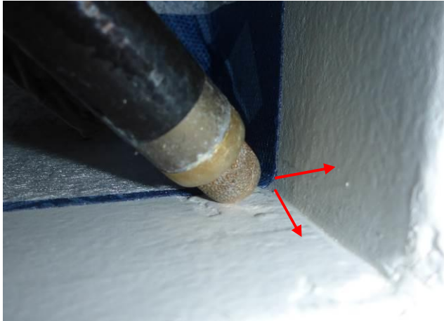
Kuva 11. Merkkiainelaitteella havaittiin ilmapuotoja kaikista nurkkakappaleen reunan ja ikkunapielien nurkkakohdan havaituista raoista. Vuodot olivat voimakkuudeltaan kohtalaisia.
