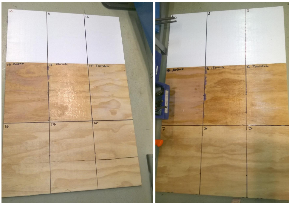
Kuva 54. Vanerialustat ennen liitosnauha-asennuksia.
