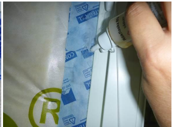
Kuvat 19 ja 20. Merkkisavulla tehdyt havainnot ilmavuodoista olivat yhteneviä merkkiainekokeesta saatujen tulosten.
