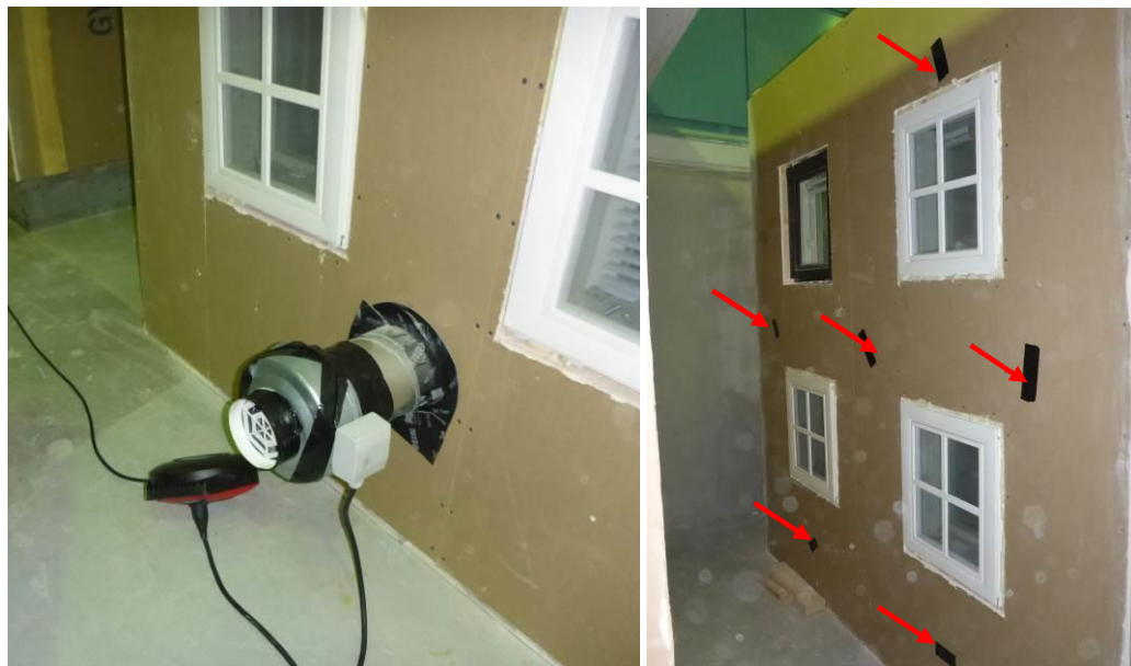
Kuvat 7 ja 8. Testijärjestely vasemmalla alipaineistukseen käytetty kavanapuhallin, oikealla merkkikaasun syöttöpisteitä ulkoseinärakenteessa.
