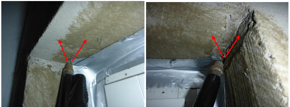
Kuvat 9 ja 10. Merkkiainelaitteella havaittiin ilmavuotoja kahdesta nurkasta, kohdista, joissa jo aistinvaraisessa tarkastelussa havaittiin mahdollisia ilmayhteyksiä nurkkaliitoksen läpi
