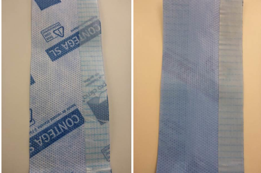
Kuvat 2 ja 3. Liimapinta on asennettu 20mm:n levyisenä kaistana nauhan molemmille puolille, vastakkaisille sivuille.
