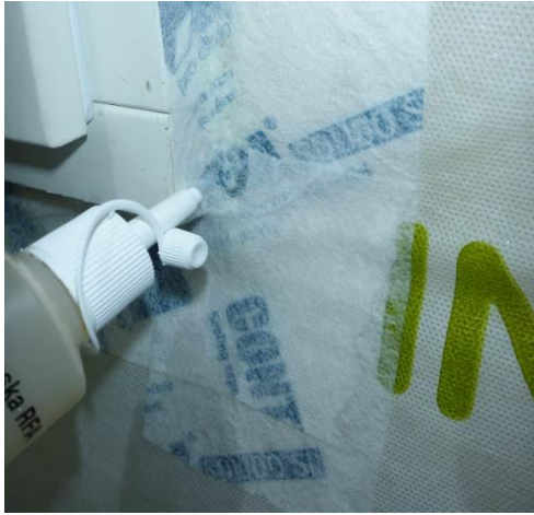
Kuva 11. Merkkisavulla tehdyt havainnot ilmavuodoista olivat yhteneviä merkkiainekokeesta saatujen tulosten kanssa.
