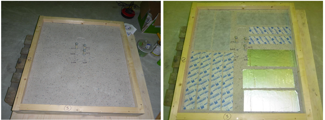
Kuva 49. Betonialusta nro. 3 ennen liitosnauha-asennuksia ja asennusten jälkeen, hiottu betonipinta ilman pohjustekäsittelyä.
