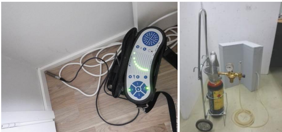
Kuva 28. Merkkiaineanalysaattori Sensistor 9012 WRS ja mitta-anturi H21 sekä merkkiaineekaasupullo, jossa virtaussäädin kaasun syötön voimakkuuden kontrollointiin (Kuvat: Tommi Syrjäläinen Vahanen Rakennusfysiikka Oy ja RT 14-11197.)
