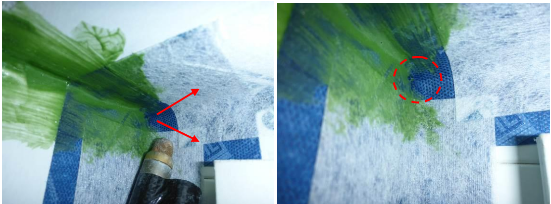
Kuvat 9 ja 10. Merkkiainelaitteella havaittiin ilmavuotoja kaikista nurkissa nurkkakappaleen takakulmista. Vuodot olivat voimakkuudeltaan vähäisiä.
