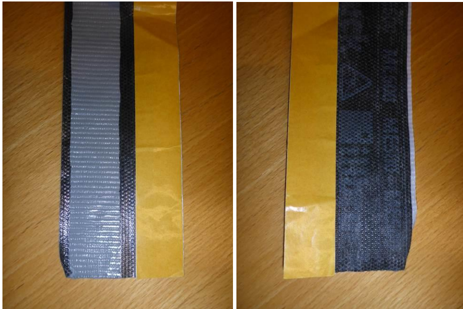
Kuva 2. Illbruck ME 500 -liitosnauha on venymätön, kuitukangasvahvisteinen tiivistysnauha. Nauhan vahvikekankaan alapinnassa on ilmatiivis muovikalvo. Nauha koostuu kahdesta osasta: kuitukangas, jonka alapintaan on asennettu butyyliiimamassa ja jäykkä muovinauha.
