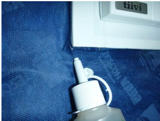
Kuvat 10. Merkkisavulla tehdyt havainnot ilmavuodoista olivat yhteneviä merk-kiaiinekoekoiden tulosten kanssa.
