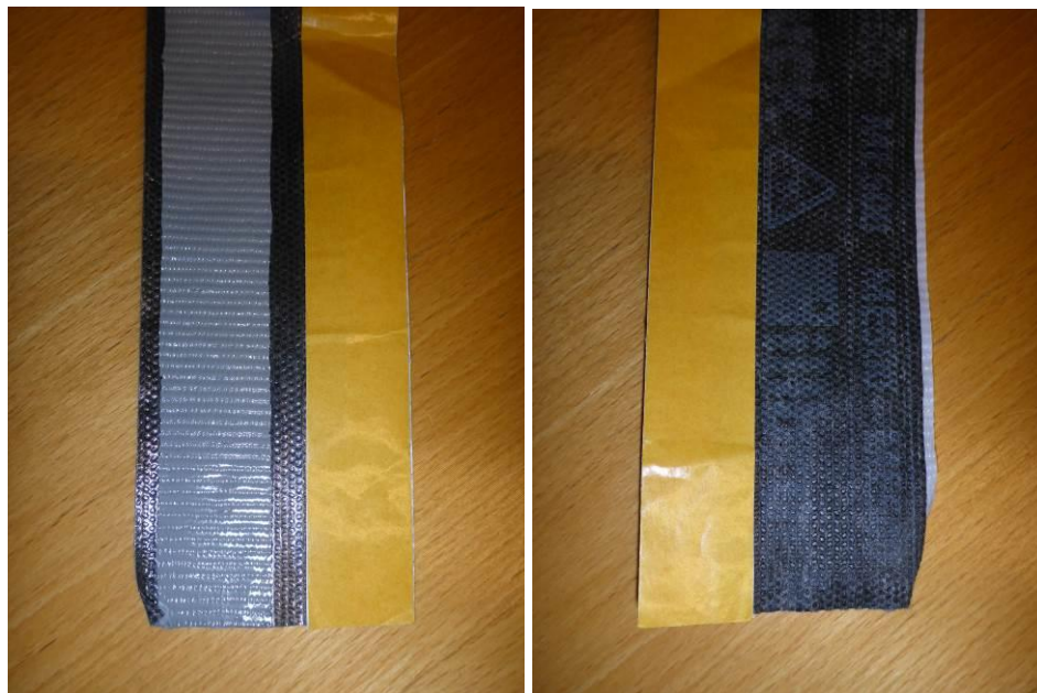
Kuva 2. Illbruck ME 500 –liitosnauha on venymätön, kuitukangasvahvisteinen tiivistysnauha. Nauhan vahvikekankaan alapinnassa on ilmatiivis muovikalvo. Nauha koostuu kahdesta osasta: kuitukangas, jonka alapintaan on asennettu butyylliimamassa ja jäykkä muovinauha.
