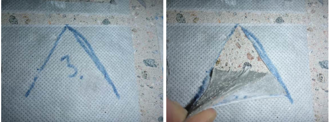
Kuva 31. Liitosnauha ennen kolmioviiltokoetta ja kolmioviiltokokeessa vedettynä kohtisuoraan alustasta poispäin (kuva: Mikko Koskivuori, Vahanen Rakennusfysiikka Oy.)
