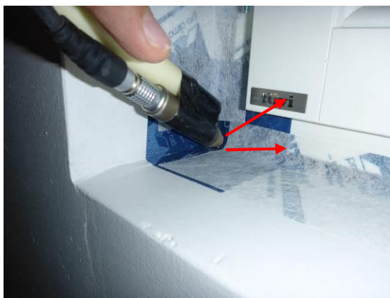
Kuvat 9 ja 10. Merkkiainelaitteella havaittiin ilmavuotoja kaikista nurkissa nurkkakappaleen taka-kulmista. Vuodot olivat voimakkuudeltaan vähäisiä.
