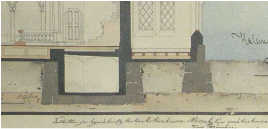
KUVA 4. Messukylän uusi kirkko on tiilirakenteinen uusgoottilainen kirkko, jonka seinien alla kulkevat jatkuvat, alaspäin levenevät luonnonkiviset perusmuurit (Tampereen seurakuntayhtymän arkisto)
