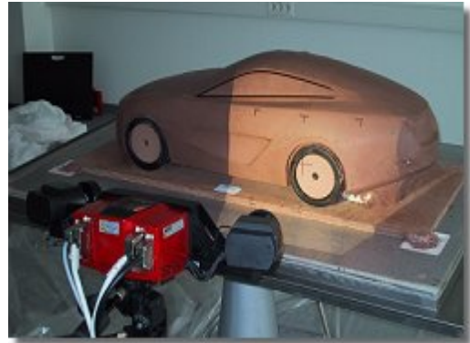
Kuva 11: Luodun mallin skannaus
