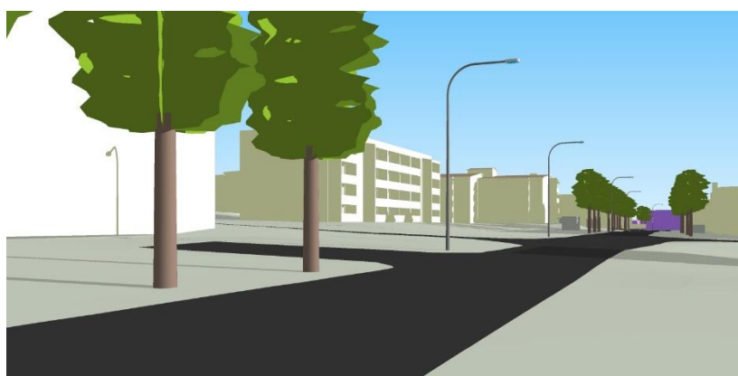
Kuva 21. Puut ja valaisimet ovat pistemäisiä kohteita. Valaisten suuntaus on kierretty käsin.
