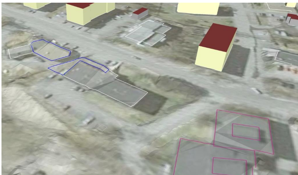
Kuva 13. Jos rakennukset eivät muodostu massamalleiksi, ne kuvautuvat rakennusviivoina.
