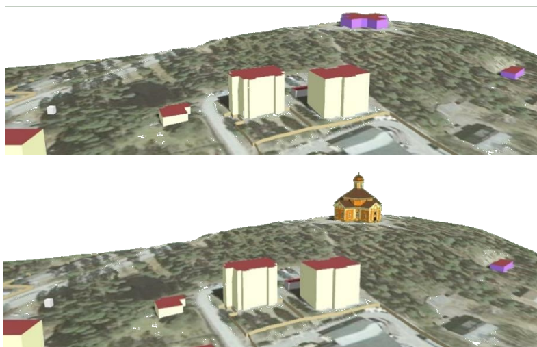
Kuva 19. Kirkon massamallirakennuksen korvaus SketchUp-komponentilla.
