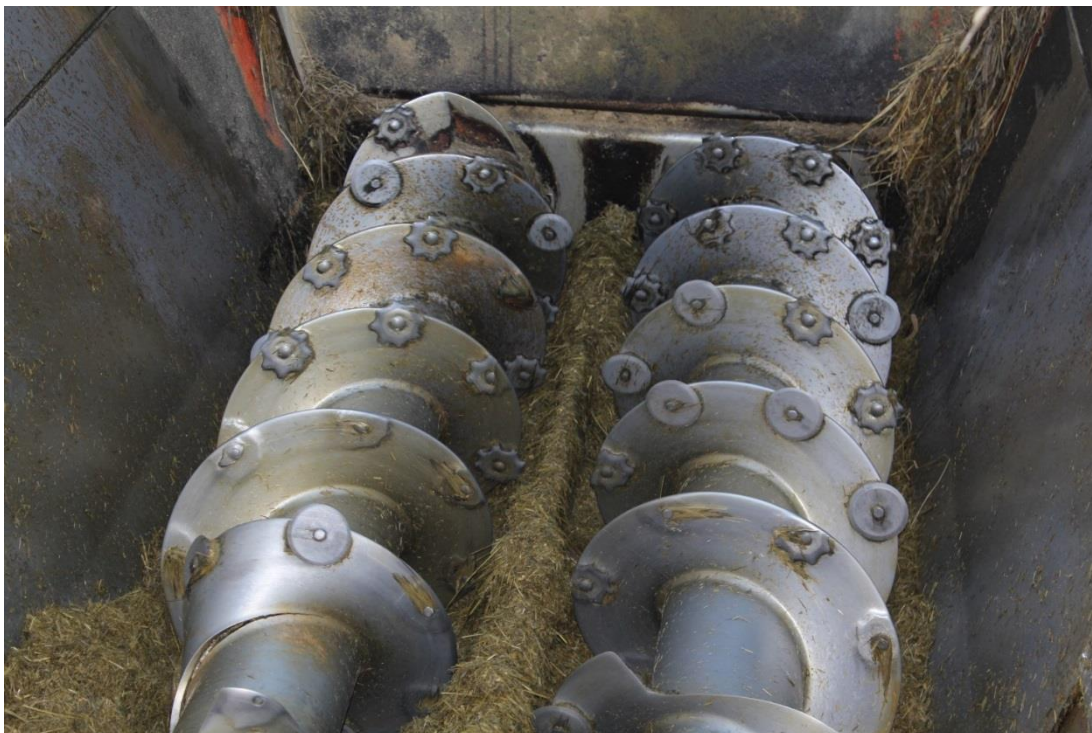
Kuva 4. Vaakaruuvivaunun piparkakku-teristä osa on kulunut täysin pyöreiksi tai kokonaan pois. (Kuva: Minna Norismaa.)
