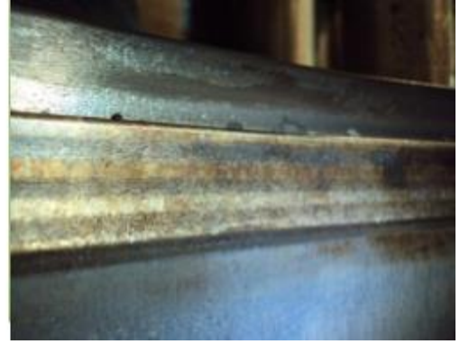
Kuva 8: Liiallisesta voitelusta johtuen ylimääräinen öljy palanut koviksi kiteiksi, mikä aiheuttaa sylinterin ja männänrenkaiden kulumista (15).
