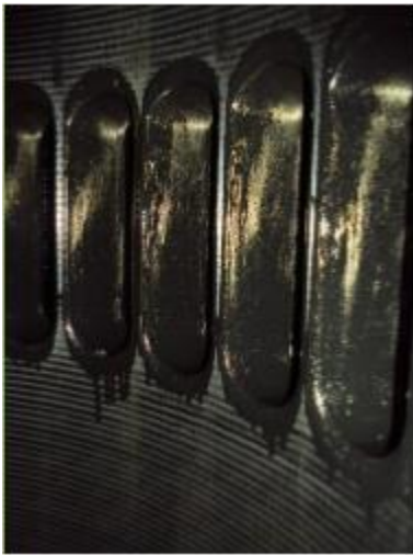
Kuva 9: Ylijäämä öljy aiheuttanut männänrenkaiden likaantumista ja lisää huuhteluilmatilan tulipalon mahdollisuutta (15).
