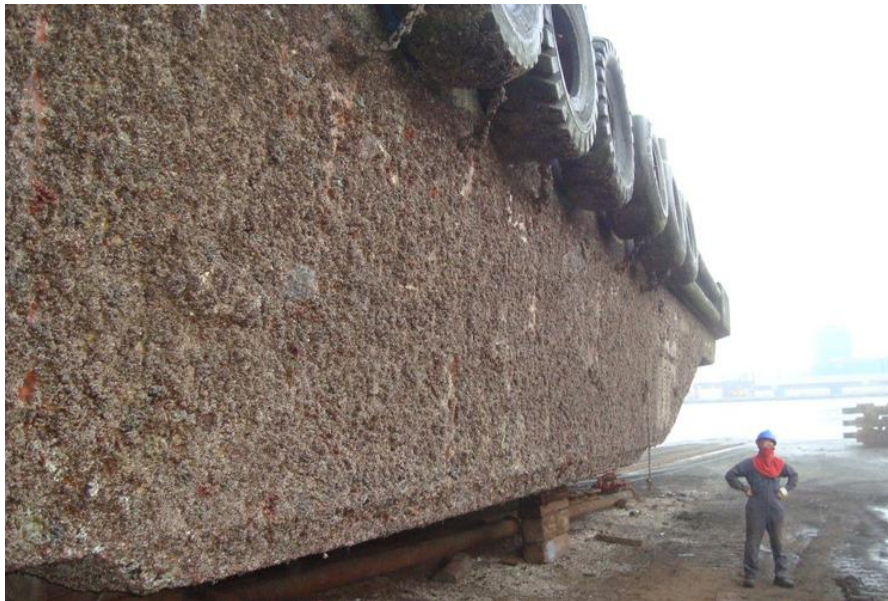
Kuva 15: Kasvuston likaama aluksen runko (25).
