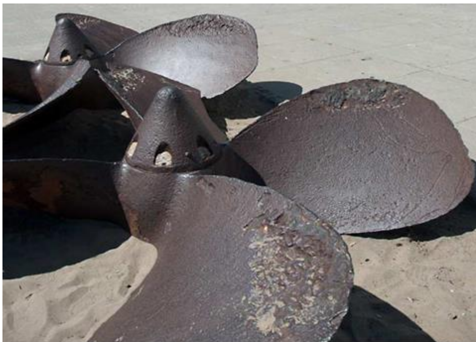
Kuva 17: Kavitaation aiheuttamaa kulumista potkureissa (28).
