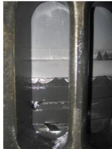
Kuva 9: Ylijäämä öljy aiheuttanut männänrenkaiden likaantumista ja lisää huuhteluilmatilan tulipalon mahdollisuutta (15).
