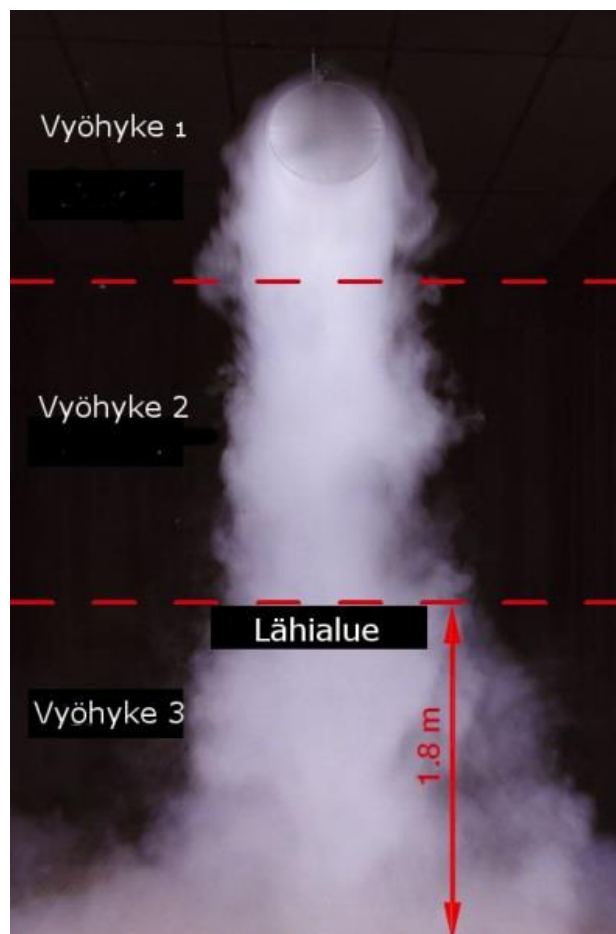
Kuva 7. Ilmanjaon vyöhykkeet (KE Fibertec 2015 s.)
