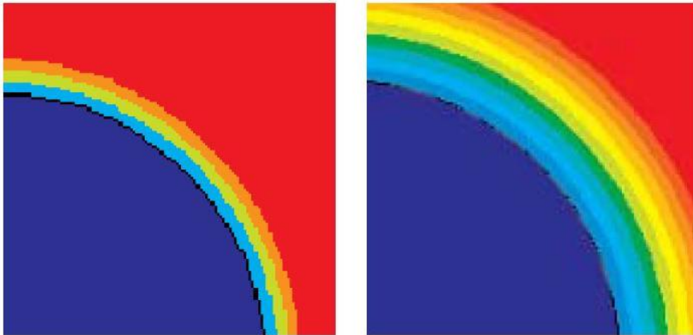
Kuva 11. Vasemmalla läpäisemättömän ja oikealla läpäisevän kankaan lämpötilagradientit (Brown et al. 2005)
