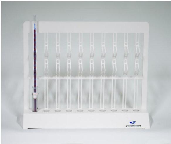
KUVA 3. Greiner Bio-Onen Westergrenin menetelmään tarkoitettu teline ja täytetty pipetti (Kuva: Marjaana Ylitalo 2016)
