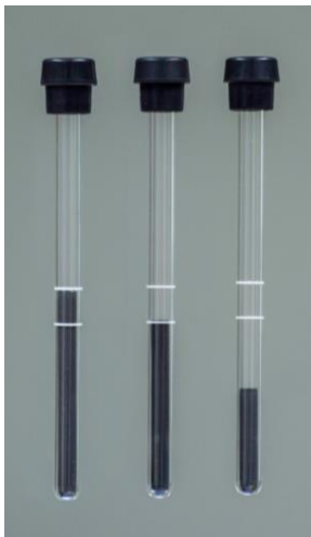
KUVA 10. Self Test -putket: vasemmalla 60 mm, keskellä 50 mm ja oikealla 30 mm putki (Kuva: Marjaana Ylitalo 2016)
