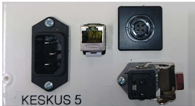
KUVA 27. Keskusten liittimet vasemmalta oikealle: virta-, RJ-45-, väylä- ja binääriliitin
