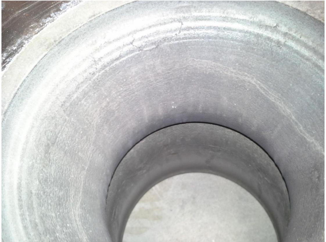
Kuvio 25. Likaa suuttimessa testien jälkeen
