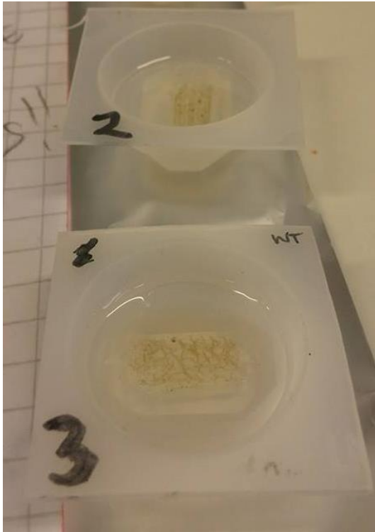
Kuvio 16. Juuripinot valetaan Solution A:n ja Historein Hardenerin seokseen leikkauspuoli alaspäin. Hypokotyyli jää valoksen yläosaan.
