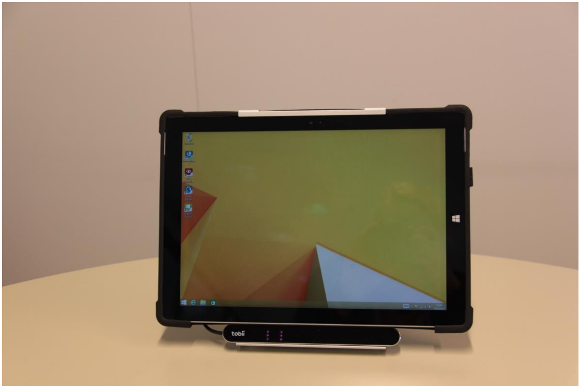
Kuvio 1. Katseella ohjattava tablet-tietokone ja Tobii PCEye Mini-katseohjausyksikkö.
