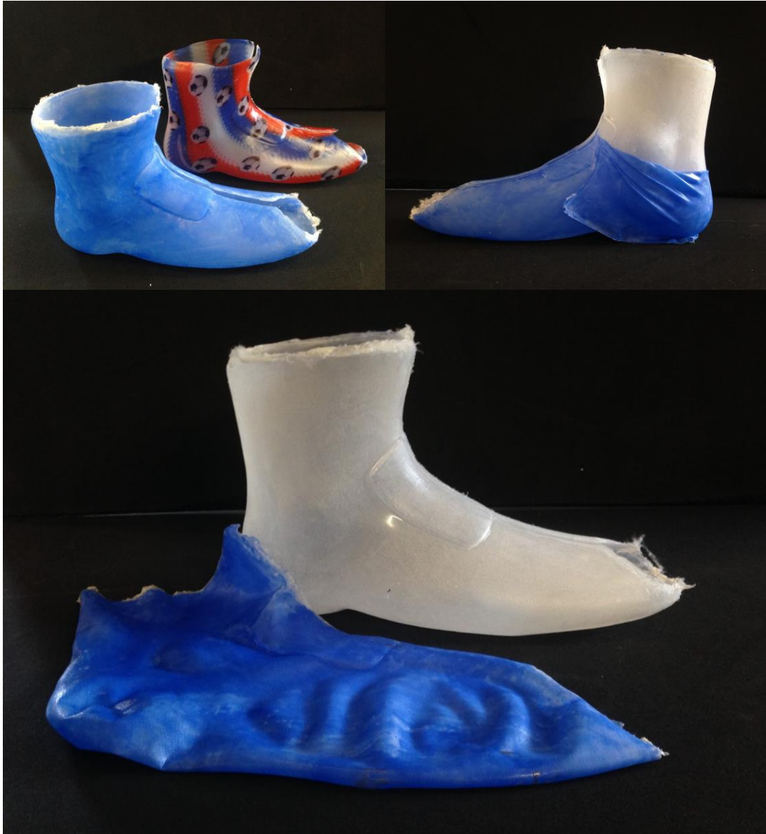
Kuvio 12. Liimanvärjäys helpotti liimattomien kohtien havaitsemista, siksi sininen liimakalvo oli yhtenäinen. Liimakalvo irtosi ehjänä Kombi-lainerin päältä.
