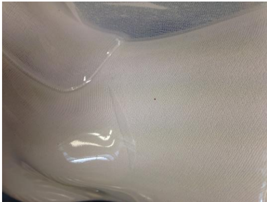
Kuvio 5. Ohut nylonsukka rypytyy herkästi muovinvedossa ja jättää jäljen Kombi-laineriin
