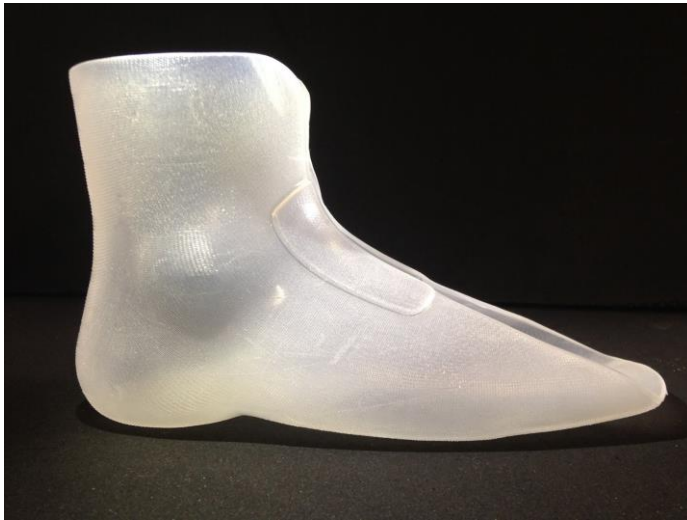
Kuvio 7. Coroplast PVC -teippi jätti laineriin teipin saumarajat, mutta lähti helposti irti
