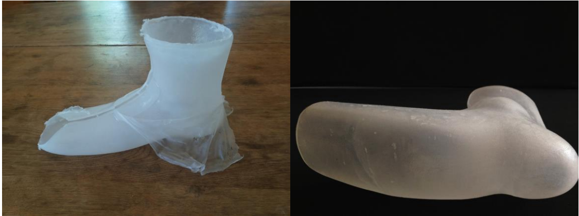
Kuvio 11. Täysimittaisessa liimakalvotestissä liimakalvo irtosi hyvin. Liimakalvoon jäi pieniä reikiä, minkä vuoksi sukka tarttui osittain kiinni laineriin. Kiinnityskohdat näkyvät pieninä valkoisina alueina
