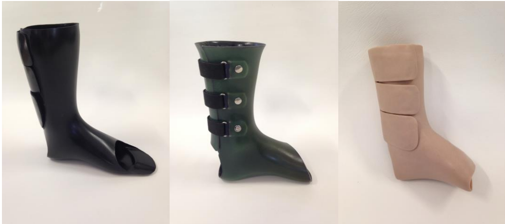
Kuvio 3. Orthonovan tuotevalikoimassa on elastisia ortooseja nilkan toimintavajauksen hoitoon: Vasemmalta alkaen LDPEstä valmistettu FlexiPod, polyuretaanista valmistettu CUAFO ja silikonista valmistettu SAFO
