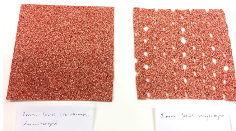
Kuvio 2. 2 millimetrin reiällinen Solid-puukuitu lämmitettynä (vas.) ja sama materiaali venytettynä lämmityksen jälkeen (oik.).
