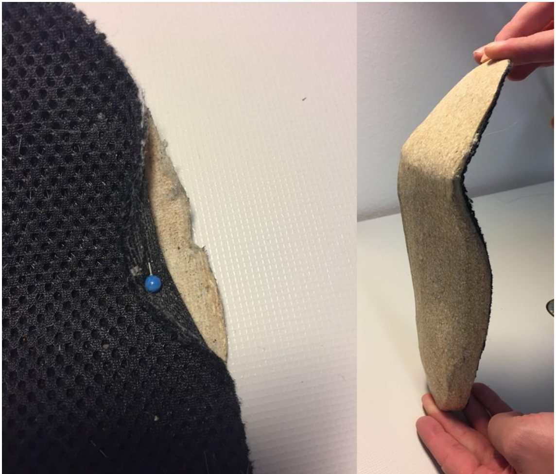
Kuvio 10. Käytetyt puukuitu-tukipohjalliset: lähikuvassa vasemmalla tukipohjallisessa tapahtunut taittuma ja lohkeama päkiän kohdalla, Oikealla puukuitupohjallinen taitettuna.
