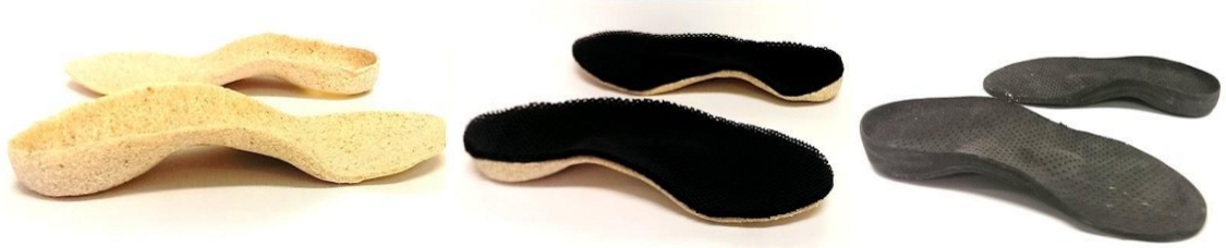
Kuvio 3. Puukuitu-tukipohjalliset hionnan jälkeen (vas.), päällystettynä Air Padding for Woodcast -pehmusteella (kesk.) ja EVA-tukipohjalliset (oik.).
