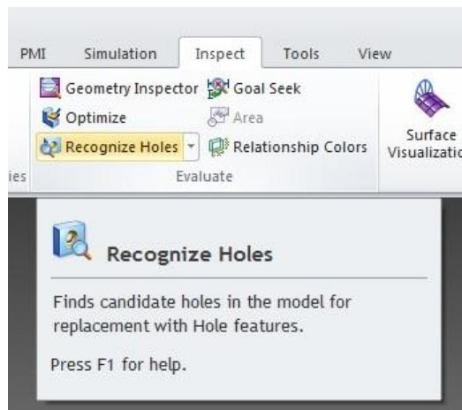
KUVA 24. Recognize Holes -työkalulla tunnistetaan reikiä
