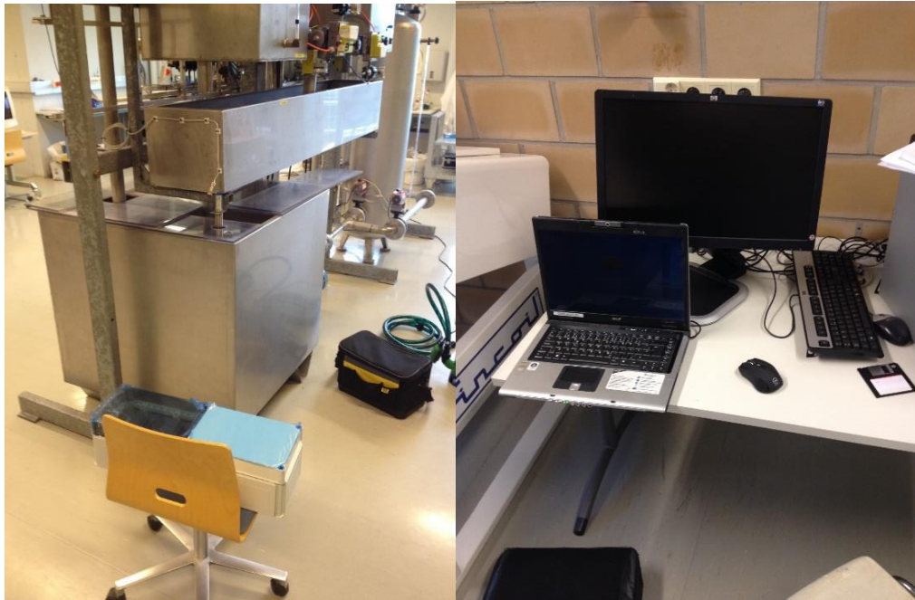
Kuvat 40 ja 41. Koetilanteessa käytetty säiliöstö ja testausympäristö. Ylempään säiliöön poistettiin vettä alemmasta säiliöstä, ja se valui yläsäiliön ja alemman keräilyssäiliön välistä poistoputkea pitkin takaisin alempaan säiliöön. Näin saatiin luotua todenmukaisen tyyppinen koetilanne pienoiskoossa.
