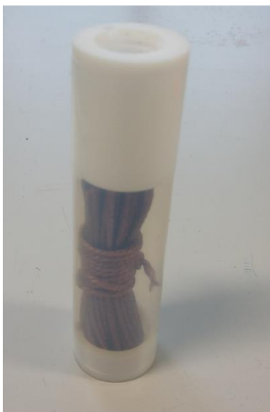
KUVA 5. Tefloninen näyteputki, jonka sisällä on koordinäyte.
