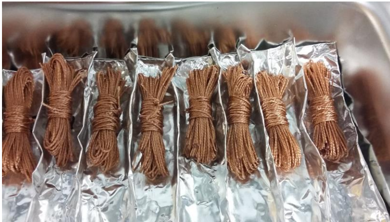
KUVA 4. Näytekeriä menossa lämpökaappiin kuivumaan.
