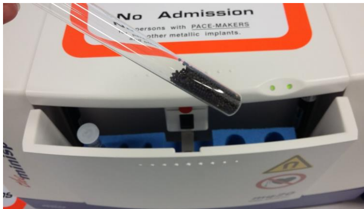
KUVA 6. Siennäyte laitteen päivittäiseen kalibrointiin.
