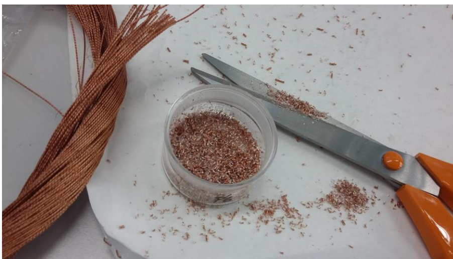
KUVA 1. Koordien leikkaaminen pieniksi paloiksi
