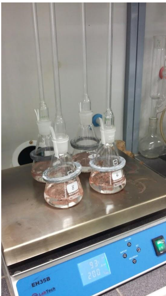
KUVA 2. Polyesterit kiehumassa 8 M kaliumhydroksidissa
