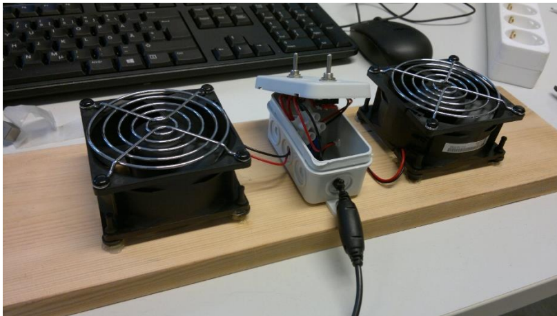
Kuva 16. Tuulettimet asennettuna värinän mittaamiseksi
