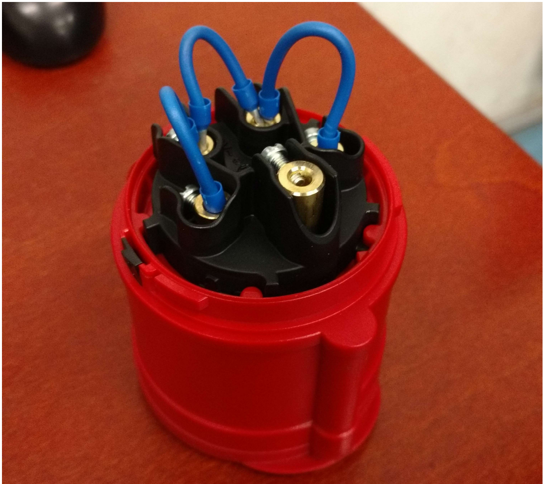
Kuva 14. Eristysresistanssin mittauksessa käytetty adapteri.
