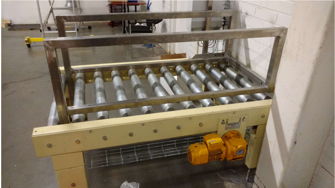
Kuva 11. Rullakuljetin ennen sähköjen asennusta.
