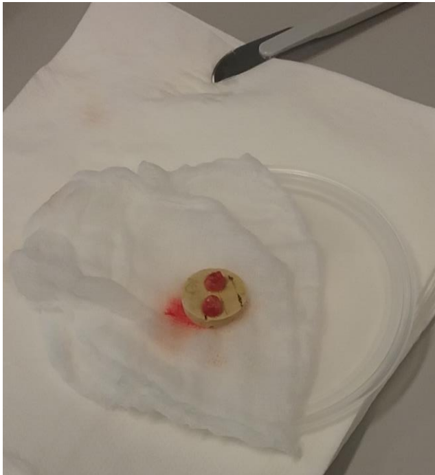
KUVA 6. Näytteiden kiinnitys korkkiin (Kuva: Sanni Nieminen & Menna Sirola 2015)
