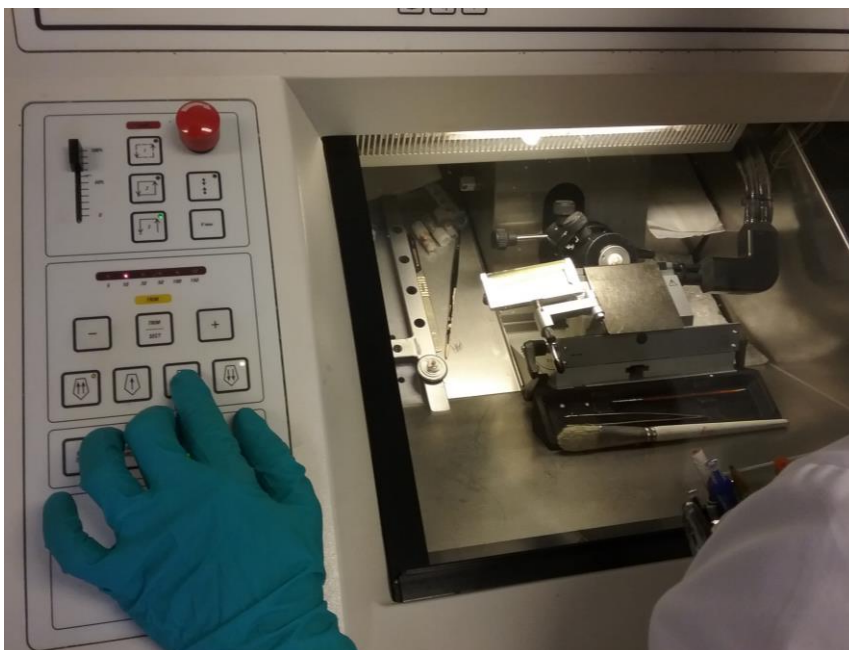
KUVA 8. Jääleikkeiden leikkaaminen kryostaatilla (Kuva: Sanni Niemine & Menna Sirola 2015)
