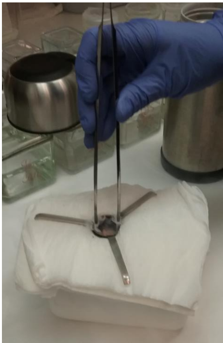
KUVA 7. Näytteen jäädytys isopentaanissa ja nestetyypessä (Kuva: Sanni Nieminen & Menna Sirola 2015)
