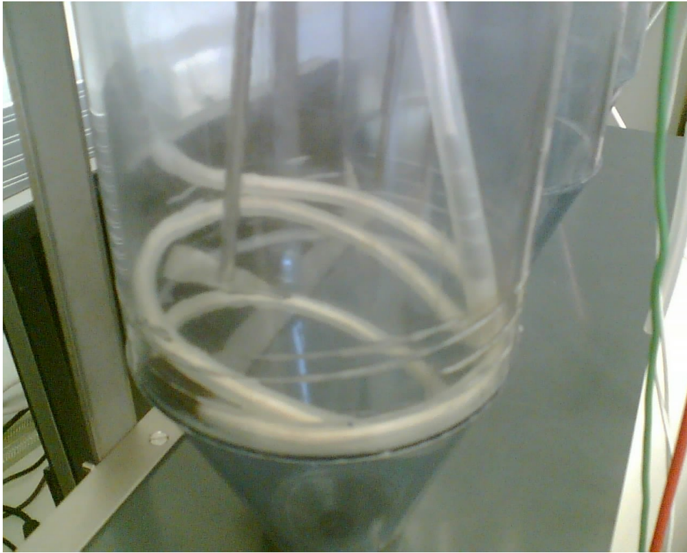
Kuva 8. Silikoniletkun sisälle pujotettu lämpötilakaapeli
