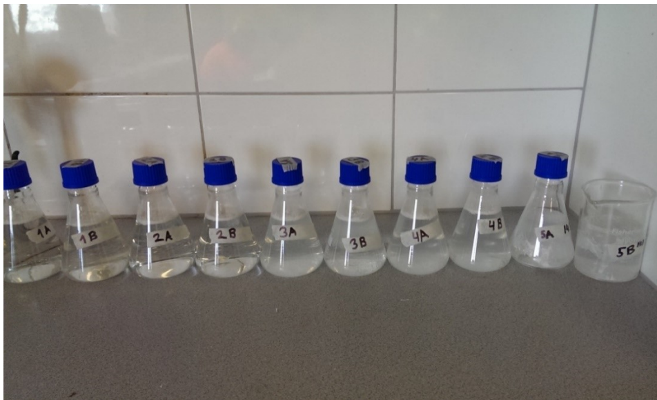
Kuva 4. Toisen liukoisuustestin näytepullot valmiina sekoittajaan.
