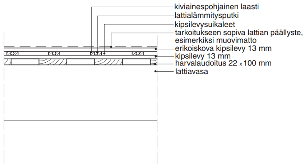
Bild 13. Golvvärme i trossbotten med gipsskivs remsor. (RT 52-10801).
