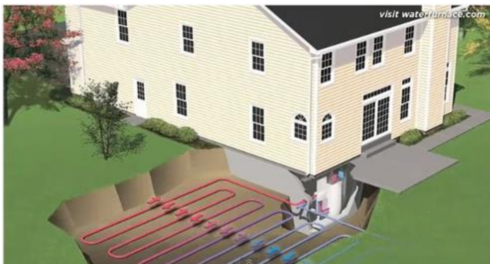
Bild 5. Markvärmens kollektorslang. (Crossheating.com).
