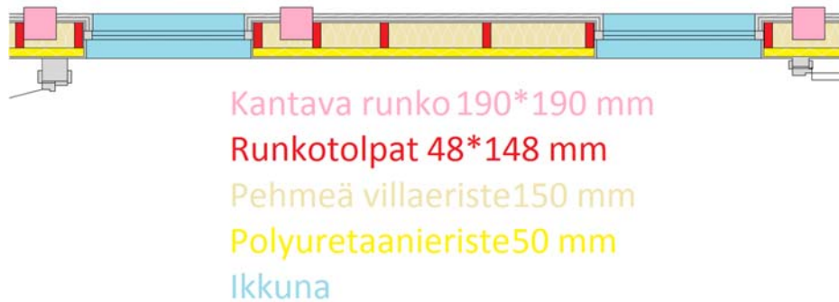
Kuvio 1. Olemassa oleva seinärakenne (mukaillen Artichouse Oy 2016)
