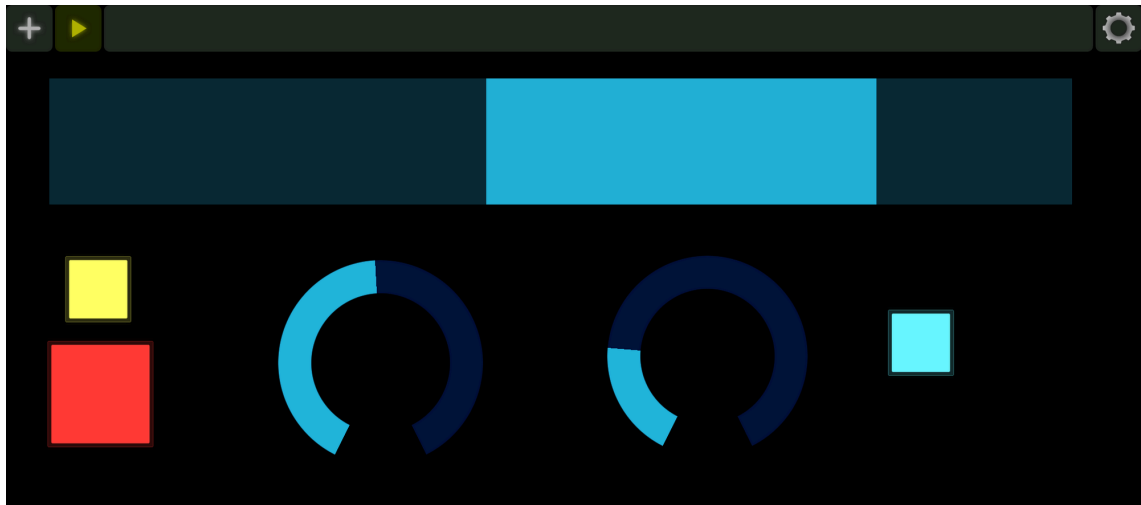
KUVA 6. Ipadilla käytettävän Lemur-ohjelman käyttöliittymä, jossa ylimpänä representaatio Fragmentin aikajanasta. Alla kontrollit nauhoittamiselle, bufferin tyhjentämiseksi, äänenkorkeuteen vaikuttavan potentiometrin kytkemiseksi päälle, toistonopeudelle, sekä hienosäätö äänenkorkeudelle. (Huttunen, 2016)
