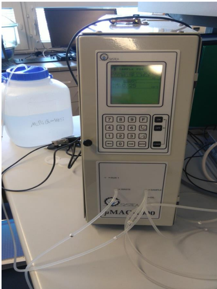
Kuvio 1. Biotalousinstituutin MicroMac1000 fosfaattifosforianalysaattori
