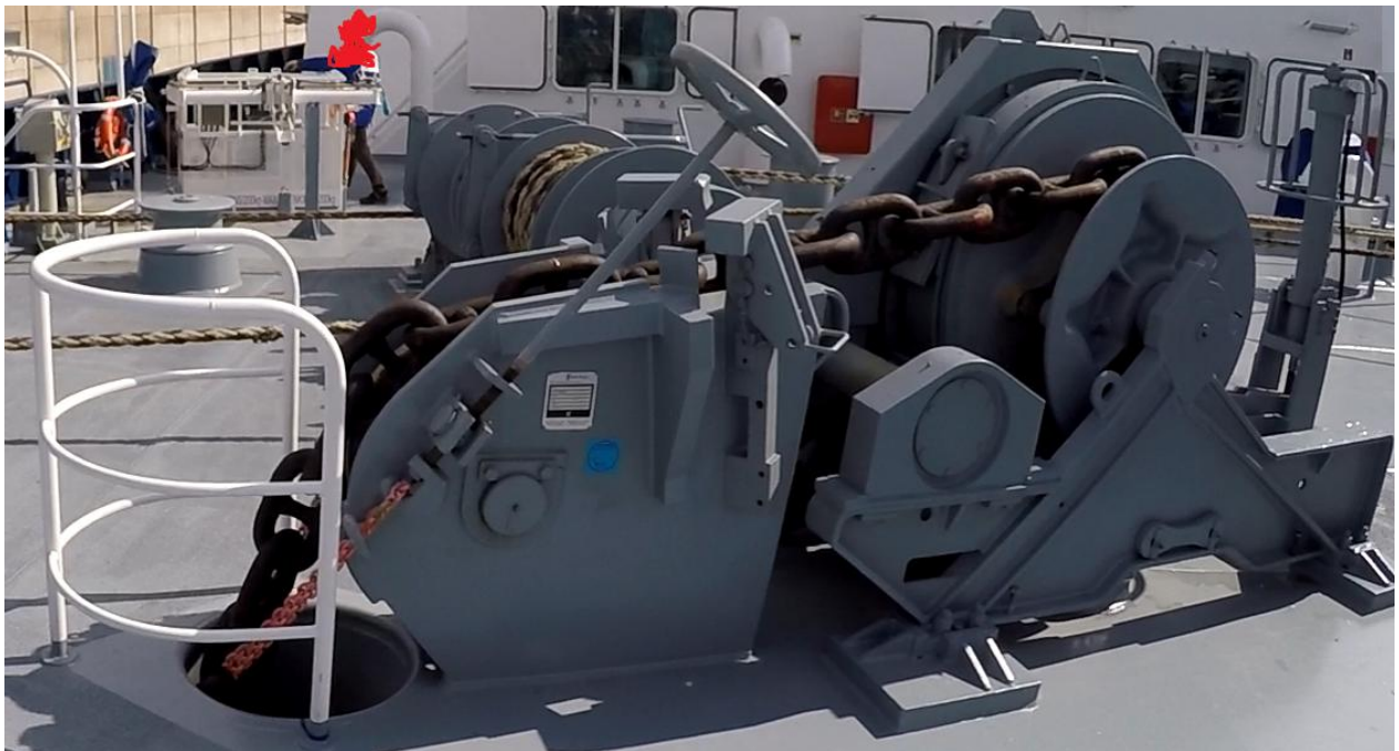
Kuva 10. Ankkurivinssi ja taittopyöräpyörä liikenneviraston laivassa Polaris
