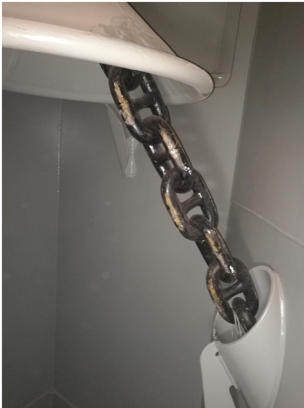
Kuva 5. Laukaisinlaite ja ohjausputki ankkurilokeron sisällä
