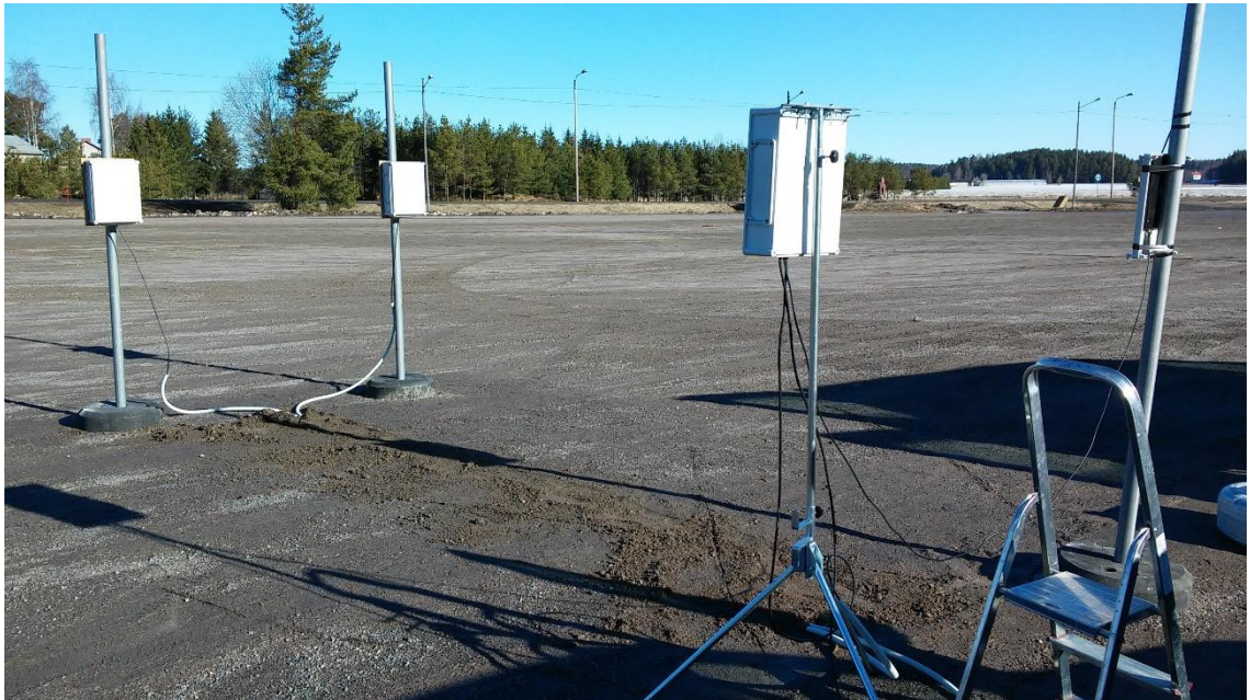
Kuva 3. RFID-lukija ja kolme lisäantennia ensimmäisissä ajoneuvomittauksissa.
