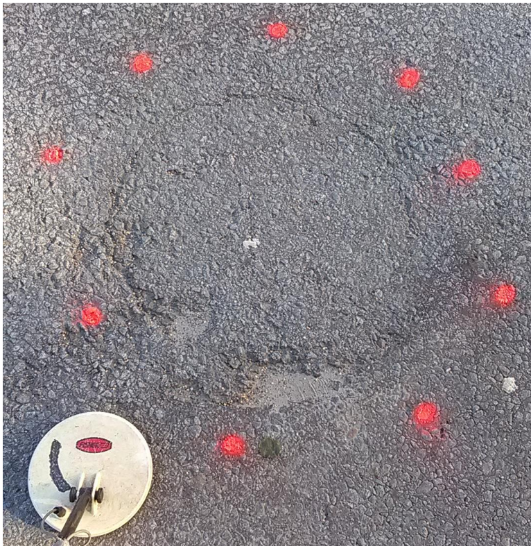
Kuvio 9. Esimerkki metallinpaljastimella löydetystä kaivosta
