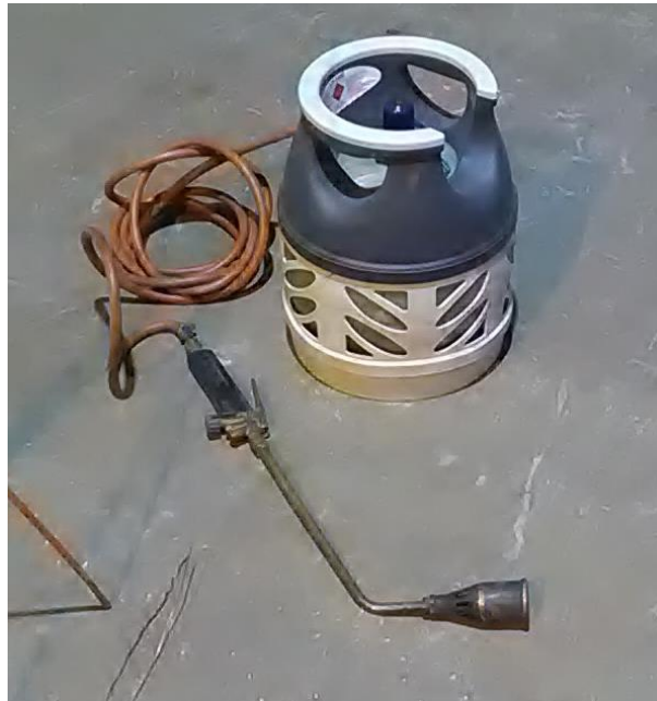
Kuvio 6. Kaivon kansien aukaisuun tarvittava kaasupoltin
