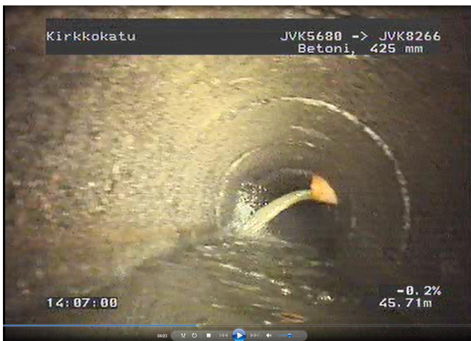
Kuvio 15. Kuvakaappaus viemäriin kuvausvideosta (Seinäjoen Vesi 2016b)
