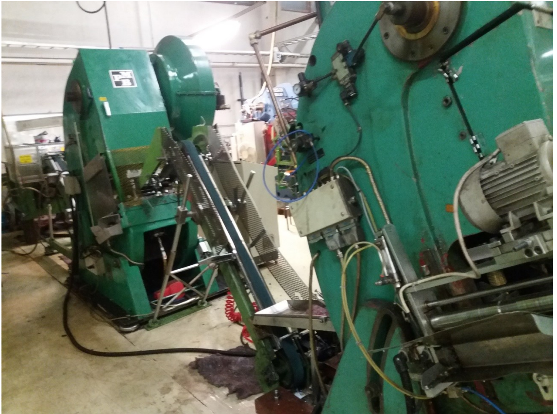
Kuva 12. Kuvassa irrotus – ja muotoiluprässit, kumitus – asema takana.
