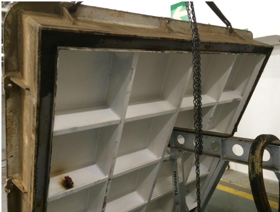
Kuva 15. Autokannen luukun kumin vaihto operaatio käynnissä. Vanha kumi irroitettu ja seuraavaksi olisi tarkoitus puhdistaa tiivisteura.
