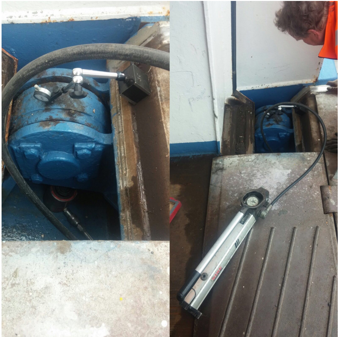
Kuva 4. Tarkistetaan rampin välyksiä tunkin ja heittokellon avulla.
