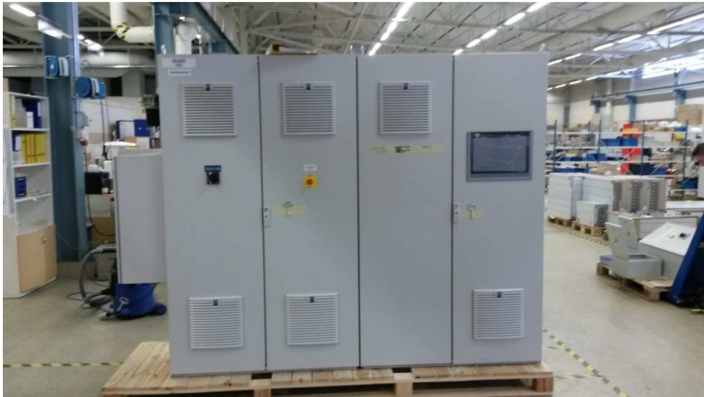
KUVIO 28 Pääsähkökeskus keskusvalmistuksessa
