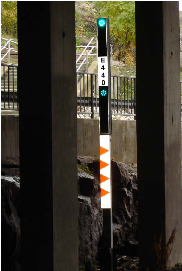
Kuva 54. Liikenneviraston yhdistelmäopastin, jolla voidaan näyttää pää-, esi- ja raideopastimen opastinkäsitteet.
