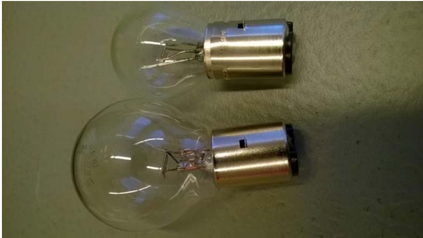
Kuva 44. Kuvissa näkyvät lampunkannan lukitukseen tarvittavat kielekkeet.
