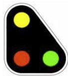
Kuva 4. Suojastusopastin. (Liikennöinti valtion rataverkolla, Liikenneviraston ohjeita 23/2015, 22.)
