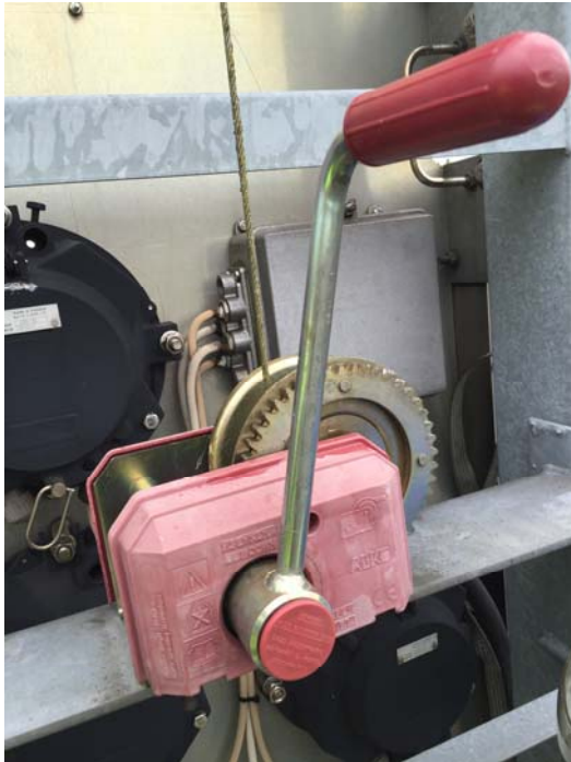
Kuva 49. Opastimien ylös veivaamiseen tarvittava kambi lähikuvassa.
