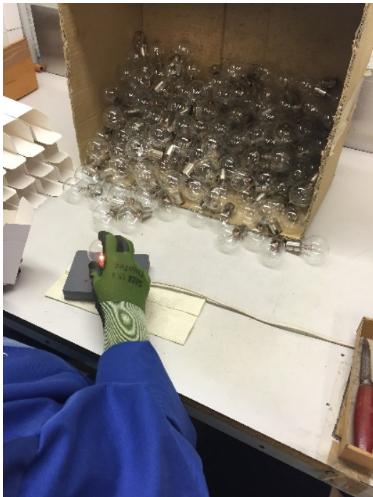
Kuva 42. Lamppua testataan ennen paketointia kopauttamalla ja polttamalla. (Tehdaskäynti, Oy Airam Electric Ab, 28.6.2016.)
