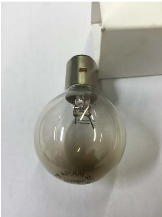
Kuva 52. Viallisessa lampussa näkyy mustaa palojälkeä kuvussa.
