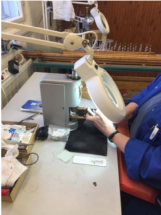
Kuva 31. Piste hitsataan elektrodit lankoineen ja tarkastetaan työn tulos.
