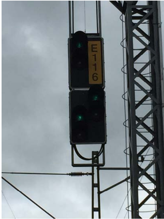
Kuva 47. Pääopastin E116, jossa AJA-opaste ja alapuolella esiopastin EoyE116, jossa ODOTA-AJA-opaste.
