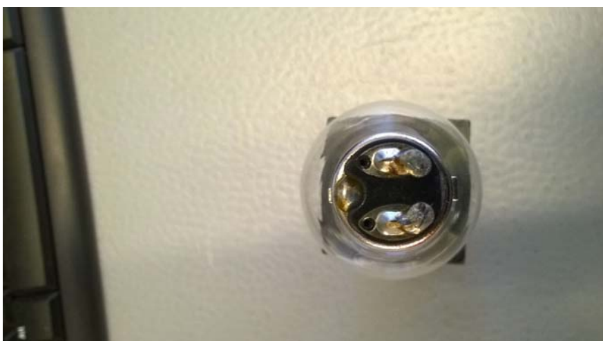
Kuva 46. Opastinlampunkanta Airamilla, tinajuotokset ja juotospastaa.
