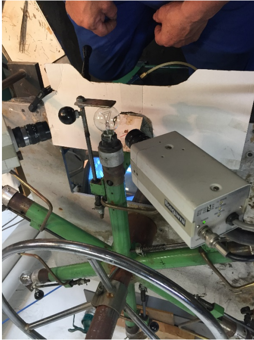
Kuva 37. Lampun kannan liittäminen kitillä ja tarkastukset.
