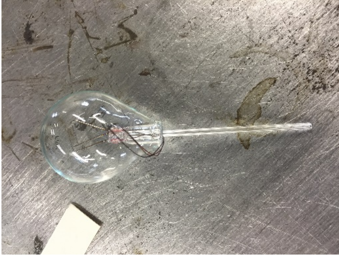
Kuva 33. Lampun kupu, elektrodit ja lasiputki valmiina kaasun täyttöön.
