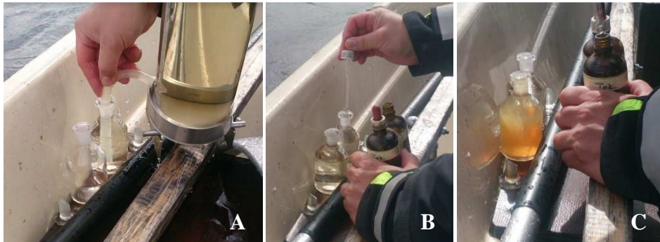
Kuva 8. Happinäytteen otto ja esikäsittely: A näytteen annostelu hiuskorkilliseen lasipulloon, B näytteen kestävöinti, C näytteen sisältämä happi on muodostanut oranssin sakan.
