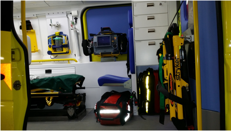
KUVA 2. Näkymä ambulanssin sivuovesta. Kaikki tavarat ovat turvallisesti kiinni eivätkä pääse vapaasti liikkumaan mahdollisen kolarin tai äkkijarrutuksen aikana.
