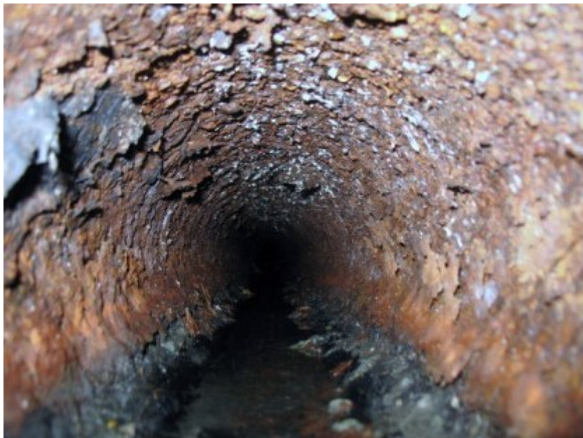
Kuva 24 Pahasti syöpynyt valurautaputki (Satpa 2016).
